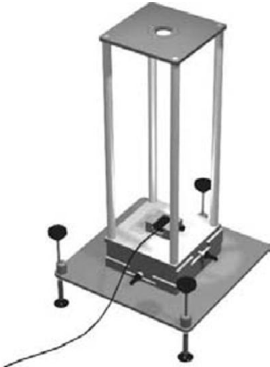
Figura 2.5 – Foto ilustrativa da mesa móvel e do sensor CCD [NERSISSIAN, 2004]
