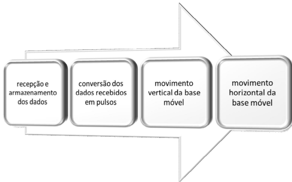
Figura 3.26 - Funcionamento do algoritmo de alinhamento automático
