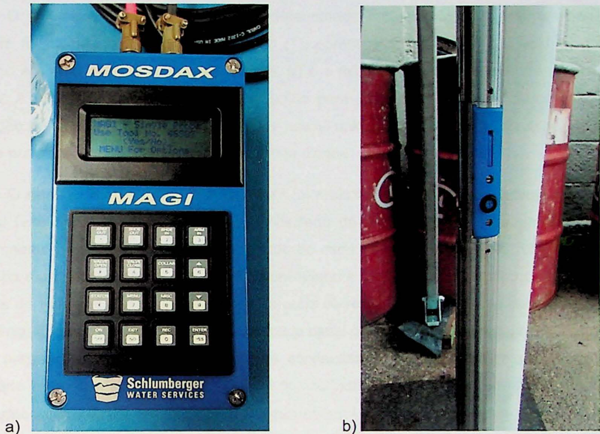
Figura 14 – a) Dispositivo que controla o sistema Westbay , b) Válvula de injeção da sonda amostradora, notar o orifício acima dela onde o “braço” da sonda fica retido.
