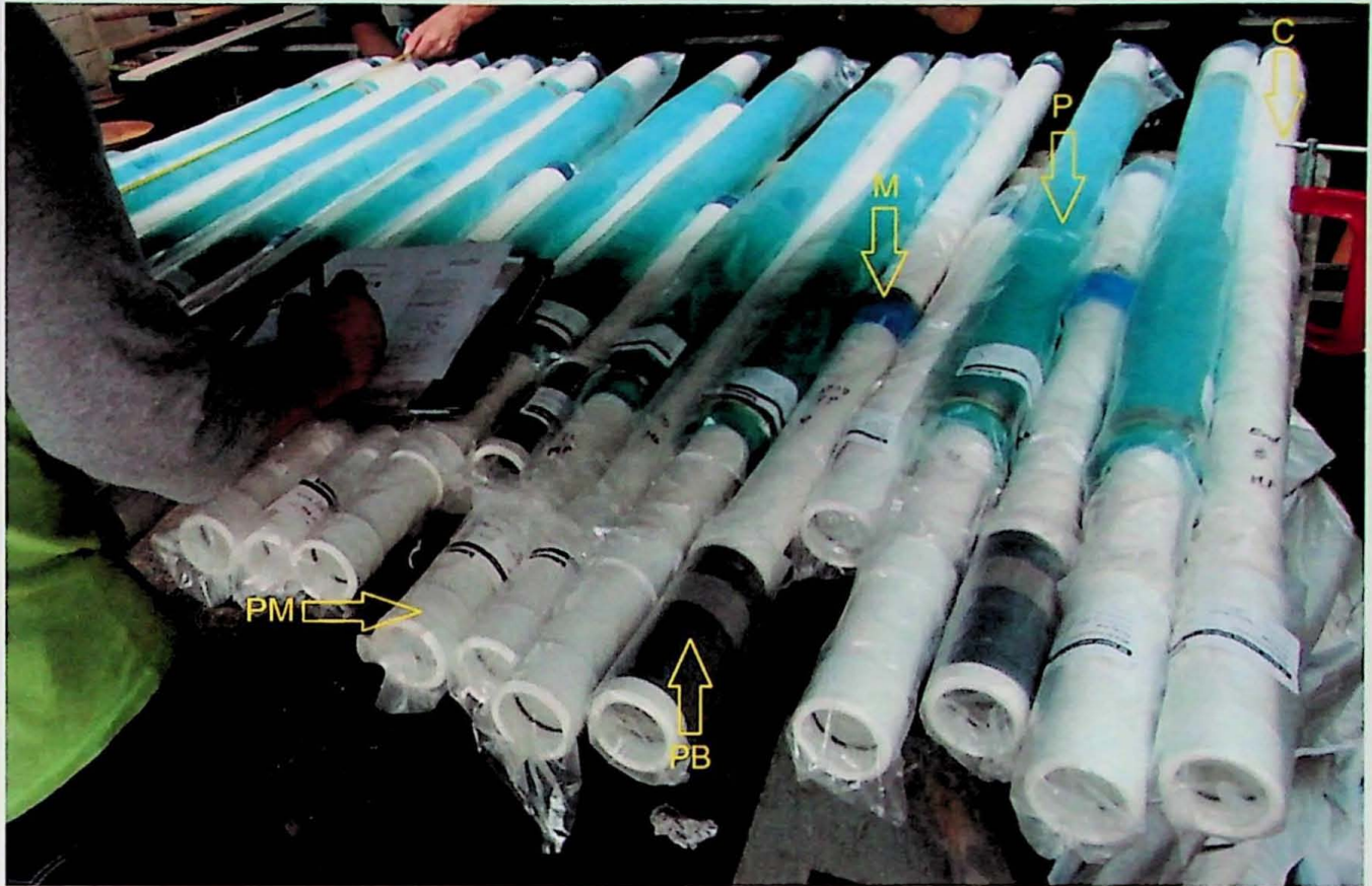
Figura 13 – Seções montadas do sistema Westbay , ordenadas e tendo seus comprimentos medidos. Os tubos azuis claro são os packers (P), os tubos cinza escuro são os couplings com portas para bombeamento (PB), as partes azuis escuro são onde estão os magnetômetros (M) e os tubos brancos variam de couplings com portas para medição (PM) a casings (C) de diversos comprimentos.
