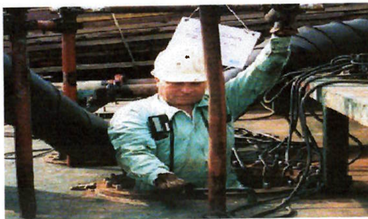
Figura 2.1: Exemplo de espaço confinado em navios petroleiros: entrada em boca de visita de um tanque de armazenamento
