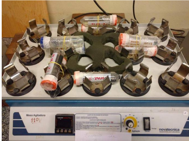
Figura 24: Amostras em agitação por um período de 24 horas em um agitador mecânico
