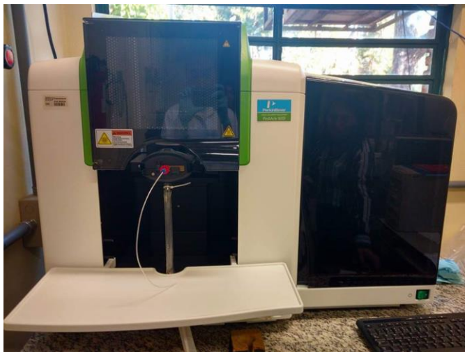
Figura 27: PerkinElmer do modelo PinAAcle 900F utilizado para a medição das concentrações de Cd nas soluções
