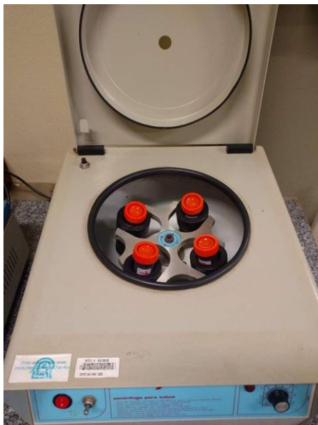
Figura 25: Amostras na centrífuga para a separação da fase sólida e líquida e facilitar na etapa de filtração
