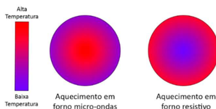
Figura 3: Comparação qualitativa dos gradientes de temperatura para amostras aquecidas em forno micro-ondas e em forno resistivo. Adaptado de 15,16 .
