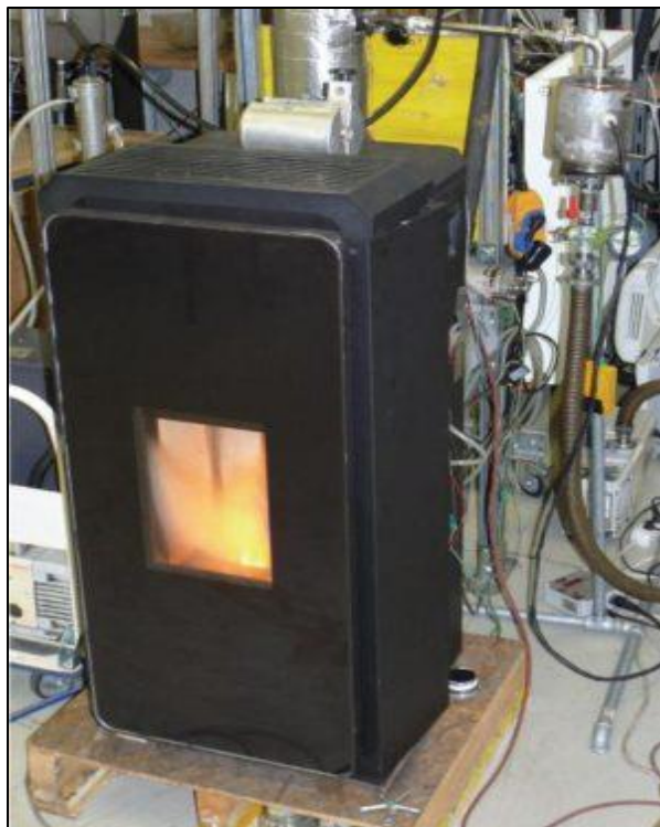
Figura 35. Prototipo de estufa de pellets con tecnología de micro cogeneración.
