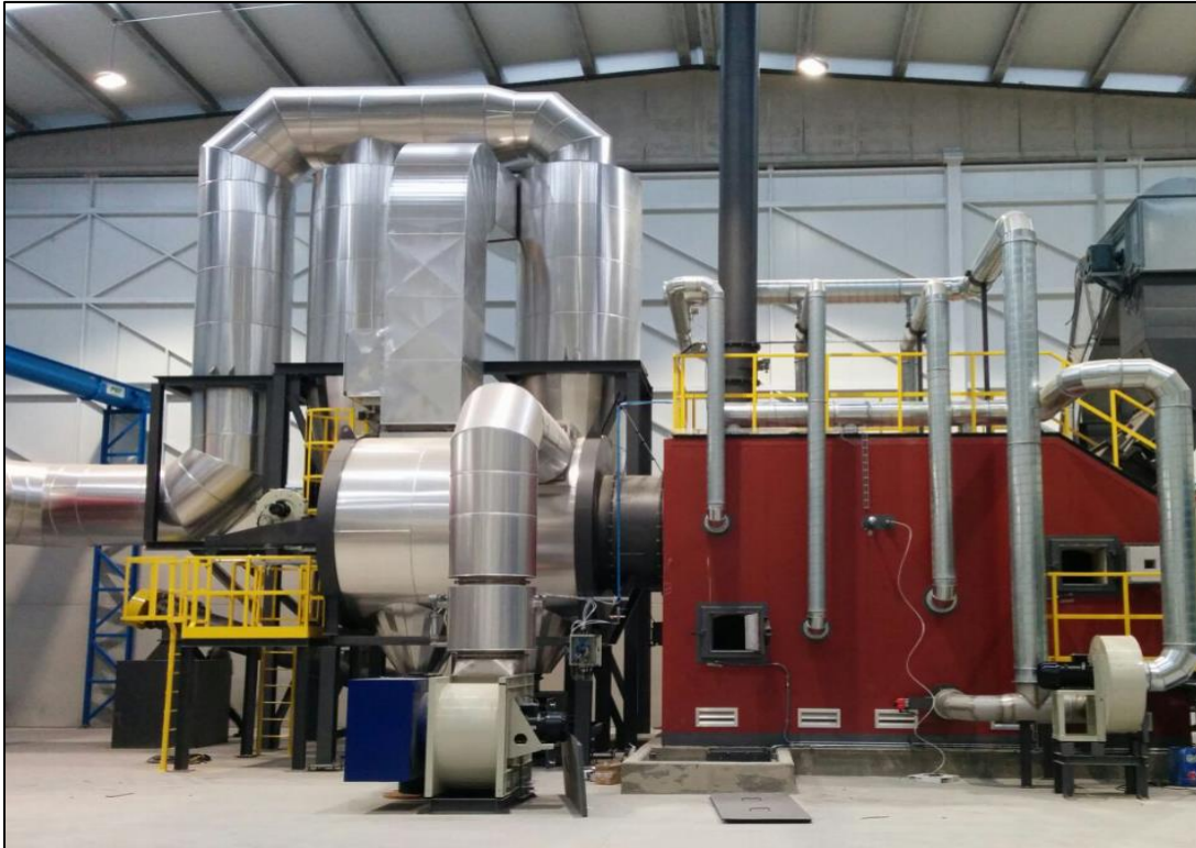
Figura 30. Generador de gases calientes: cámara de combustión junto con una cámara de dilución.
