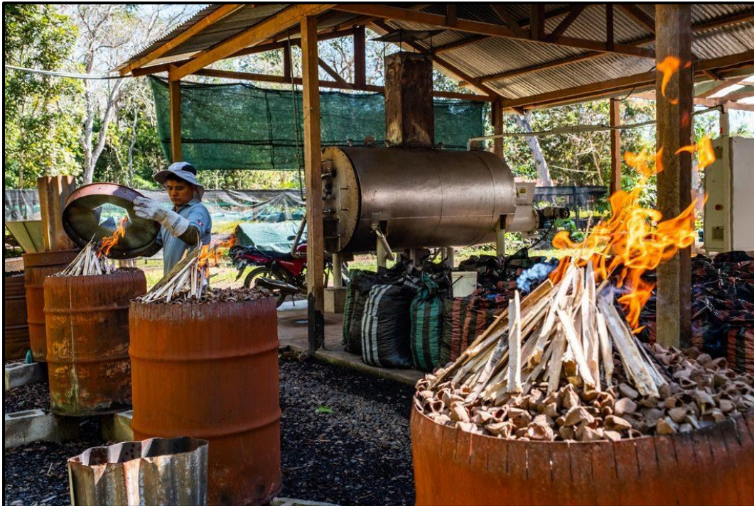
Figura 16. Pirolizador de cilindro (artesanal) y pirolizador de flujo continuo (industrial).
