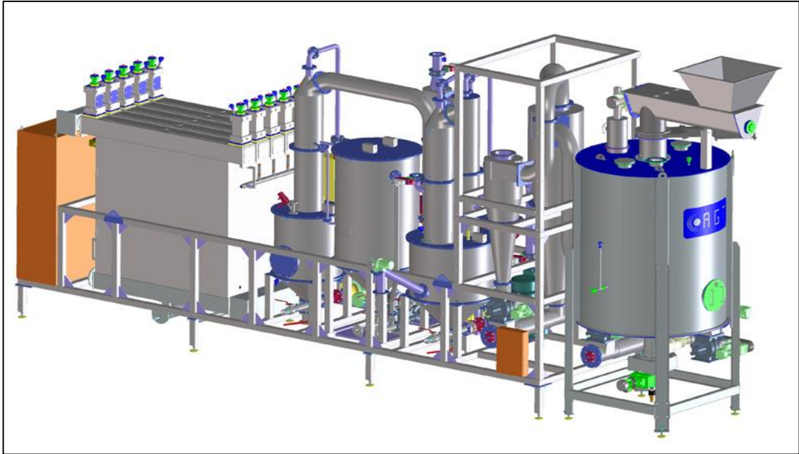
Figura 32. Modelo de gasificador de biomasa con unidad generadora de electricidad incorporada.
