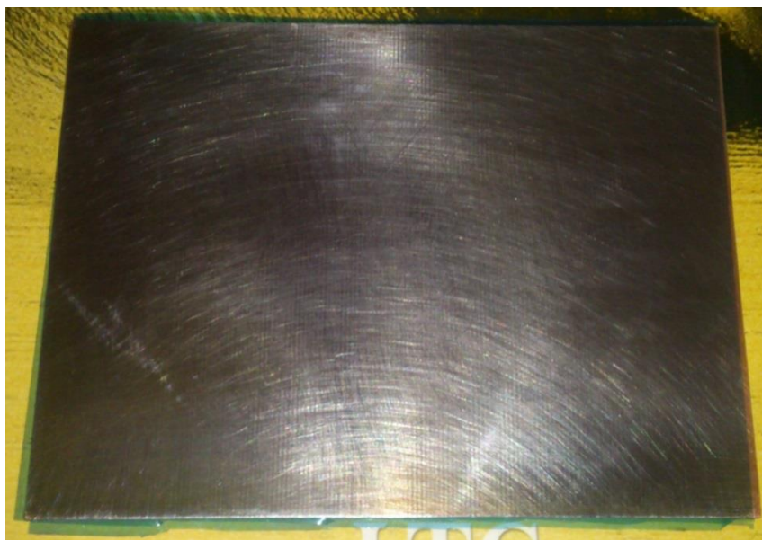
Figura A.1: Placa de circuito com dryfilm aplicado.
