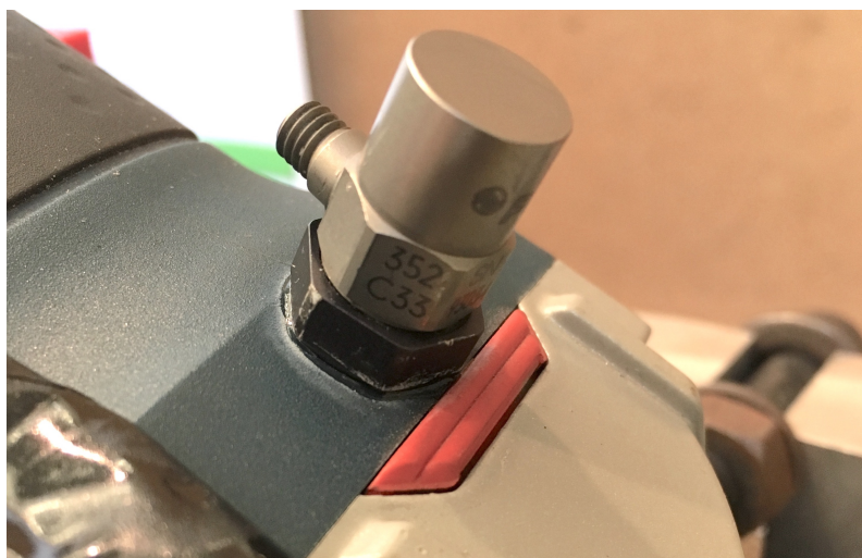
Figura 33: Acelerômetro PCB Piezotronics 352C33 fixado no eixo Z
