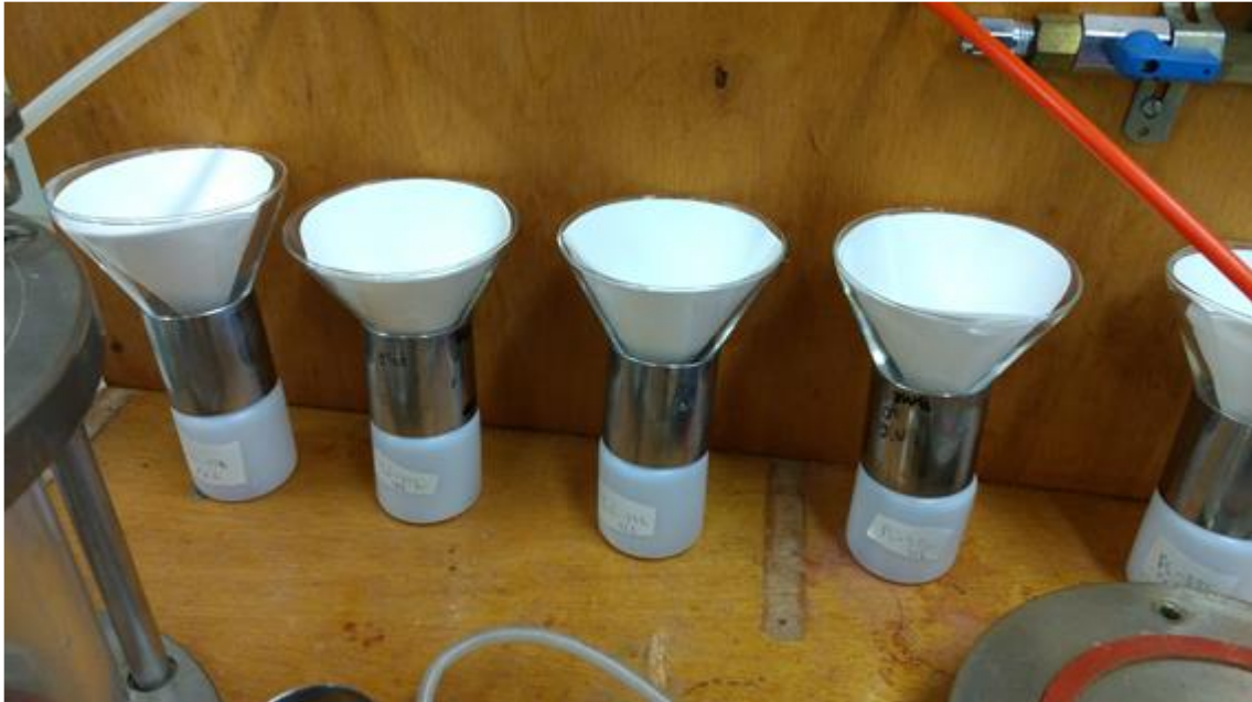
Figura 17 - Aparato de filtração
