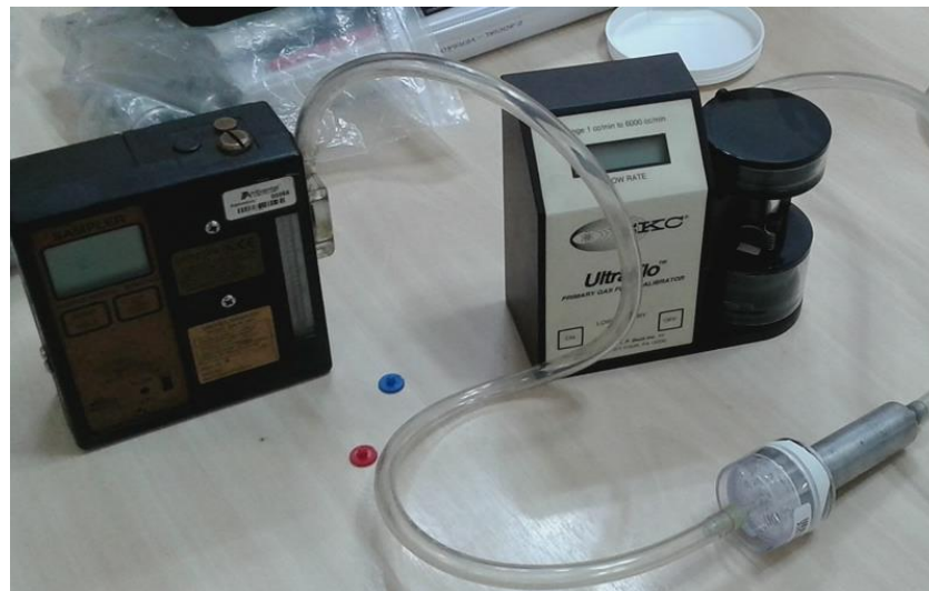
Figura 17 - Calibração da bomba de amostragem para ciclone de alumínio.
