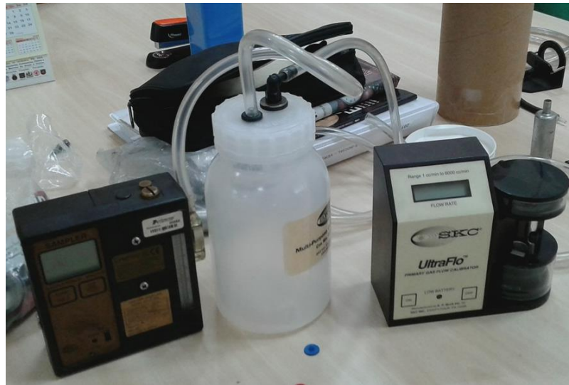
Figura 16 - Calibração da bomba de amostragem para ciclone de nylon.
