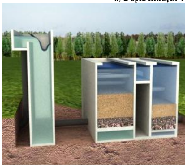
b) Instalação de dupla Filtração
