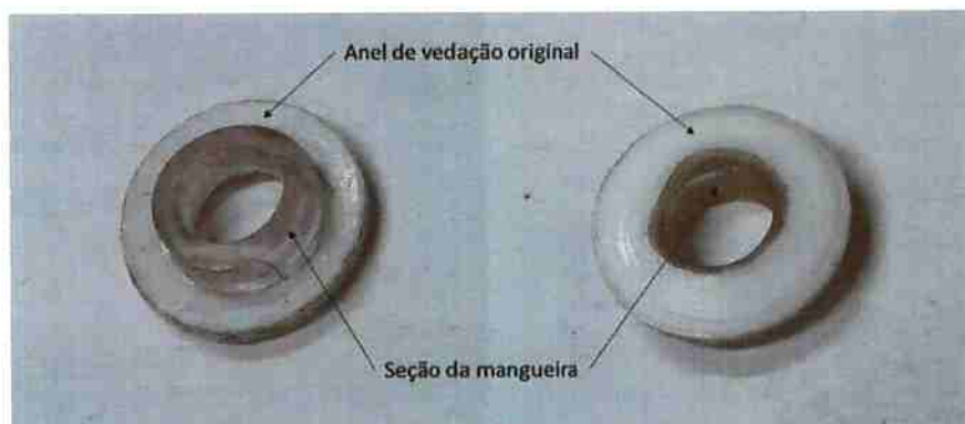
Figura 11 Pedaco de mangueira de material polimérico cortada e acoplada ao anel de vedação da célula eletrolítica plana.
