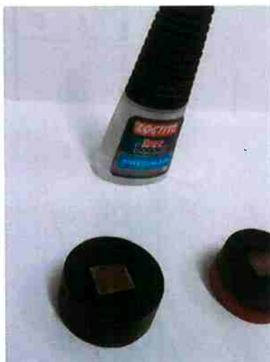
Figura 5 Corpos de prova com aplicação de super bonder na interface metal/baquelite, como tentativa para evitar a corrosão em fresta durante a polarização potenciodinâmica.
