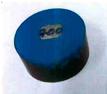
Figura 7 Exemplo de corpo de prova embutido em resina especial para evitar a ocorrência de fresta.
