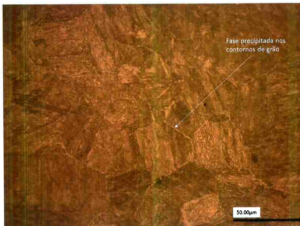
Figura 20 Micrografia obtida por microscopia óptica com aumento de 500X. Revenimento a 700°C. Reagente: Vilella.
