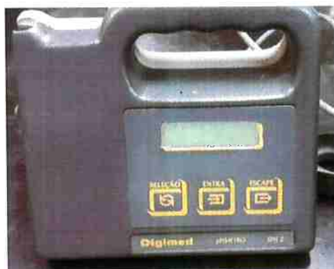
Figura 16 pHmetro utilizado para ajuste do pH do eletrólito
