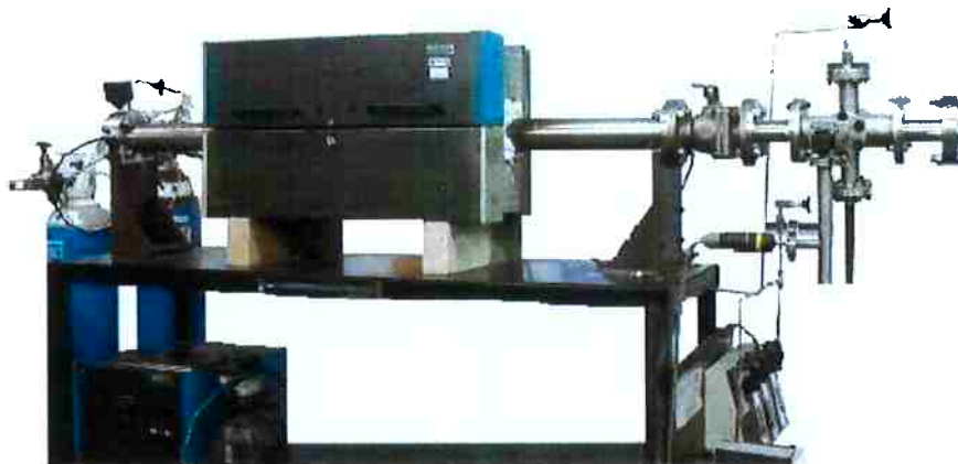
Figura 12 Forno tubular utilizado para os tratamentos térmicos. (Pertencente ao Laboratório de Ensaio Mecânicos – PMT.) (Hernández, 2014)
