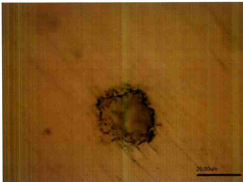
Figura 29 Pite típico nucleado nos corpos de prova após ensaio de polarização potenciodinâmica.
