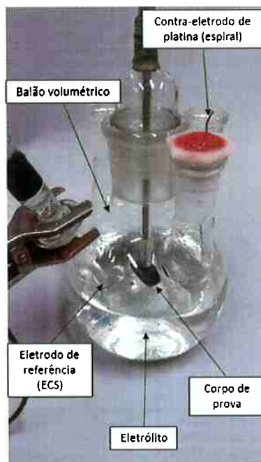
Figura 3 Célula eletrolítica tipo balão volumétrico, constituída por eletrodo de referência de calomelano saturado (ECS), contra-eletrodo (fio de platina enrolado em espiral) e corpo de prova embutido em baquelite.
