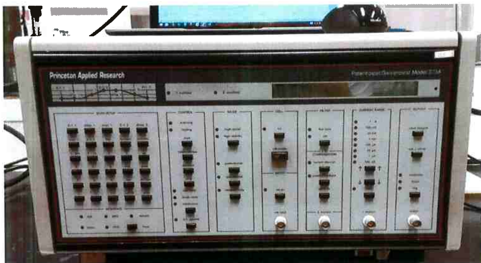
Figura 14 Potenciostato PAR 273A utilizado nos ensaios eletroquímicos.
