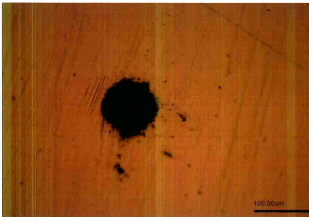
Figura 28 Pite típico nucleado nos corpos de prova após ensaio de polarização potenciodinâmica.
