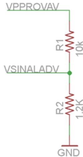
Figura 7 - Circuito para medição de tensão
