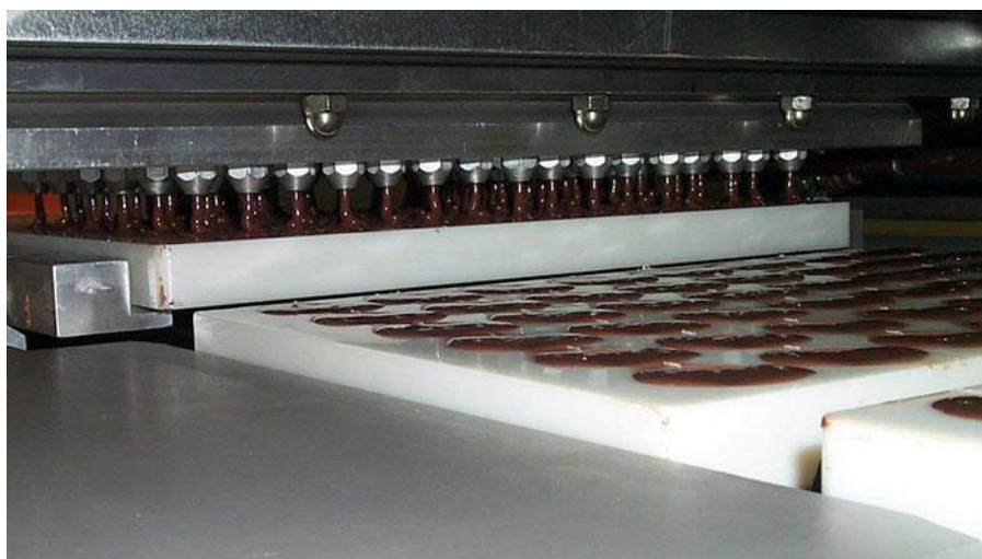
Figura 8 – Dosadora depositando chocolate nos alvéolos dos moldes de policarbonato.
