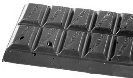
Figura 14 – Falha durante o processo de desmoldagem de um chocolate moldado por erro operacional durante ajuste de vibração.
