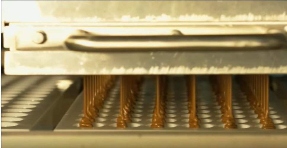
Figura 11 – Depositador preenchendo os alvéolos com massa de chocolate.
