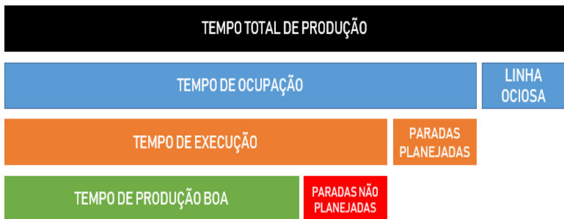
Figura 2 – Tempos de processo utilizados por performance industrial para o cálculo de eficiência global de um processo.
