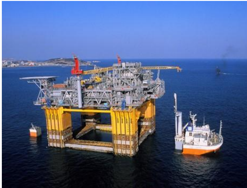
Figura 10.9 - Plataforma flutuante TLP ( Tension-Leg Wellhead ). Fonte: OSX
