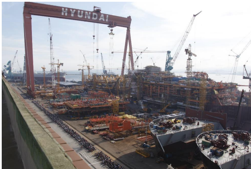
Figura 2.5 - Pórtico do tipo Goliath e região do dique seco da HHI. Fonte: Hyundai Heavy Industries
