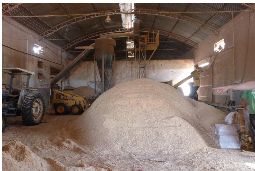
Figura A. 7 - Armazenamento de material seco e ciclone ao fundo
