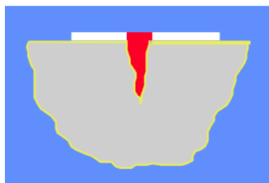
Figura 10 – Revelação da trinca (Andreucci, Ricardo, ABENDI, 2013)
