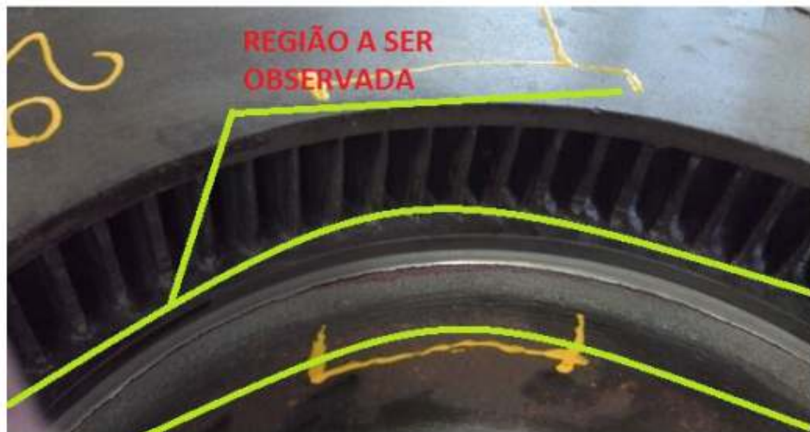
Figura 4A – região onde deve ser observado o vazamento
