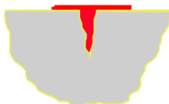
Figura 9 – Aplicação do líquido penetrante (Andreucci, Ricardo, ABENDI, 2013)
