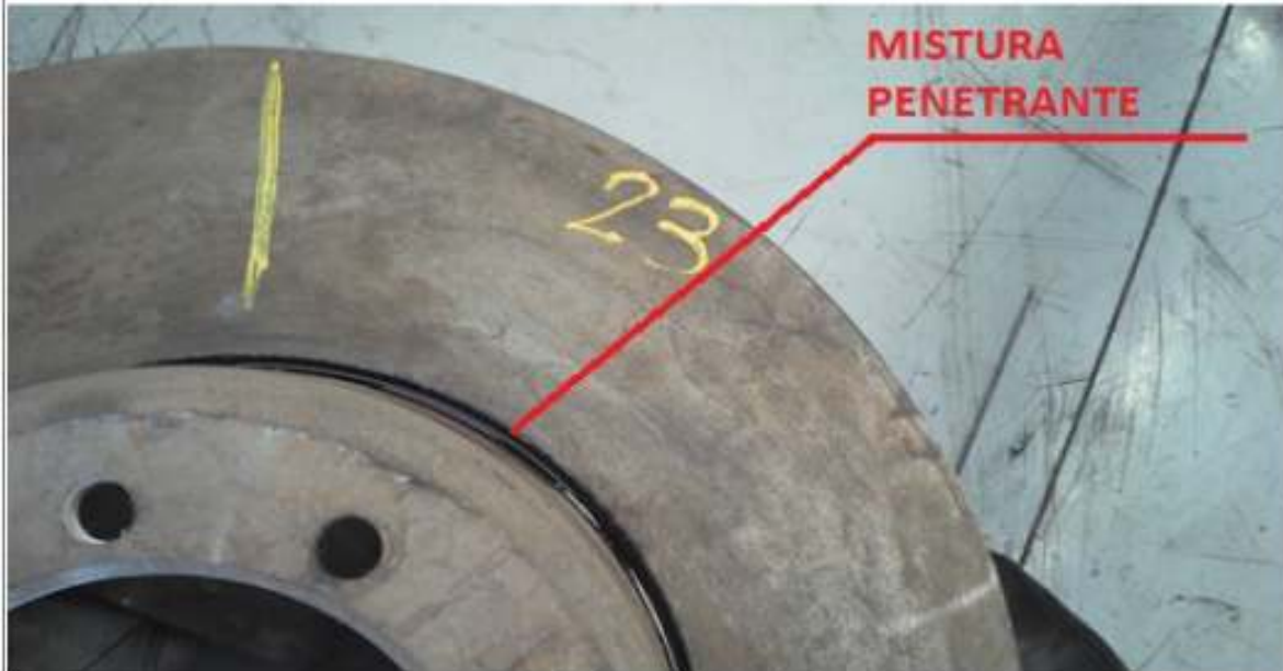
Figura 3B – cavidade com o líquido penetrante
