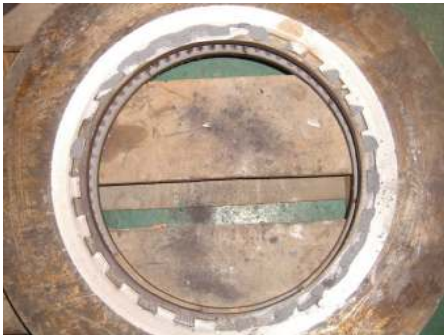
Figura 24 – Detalhes do cisalhamento
