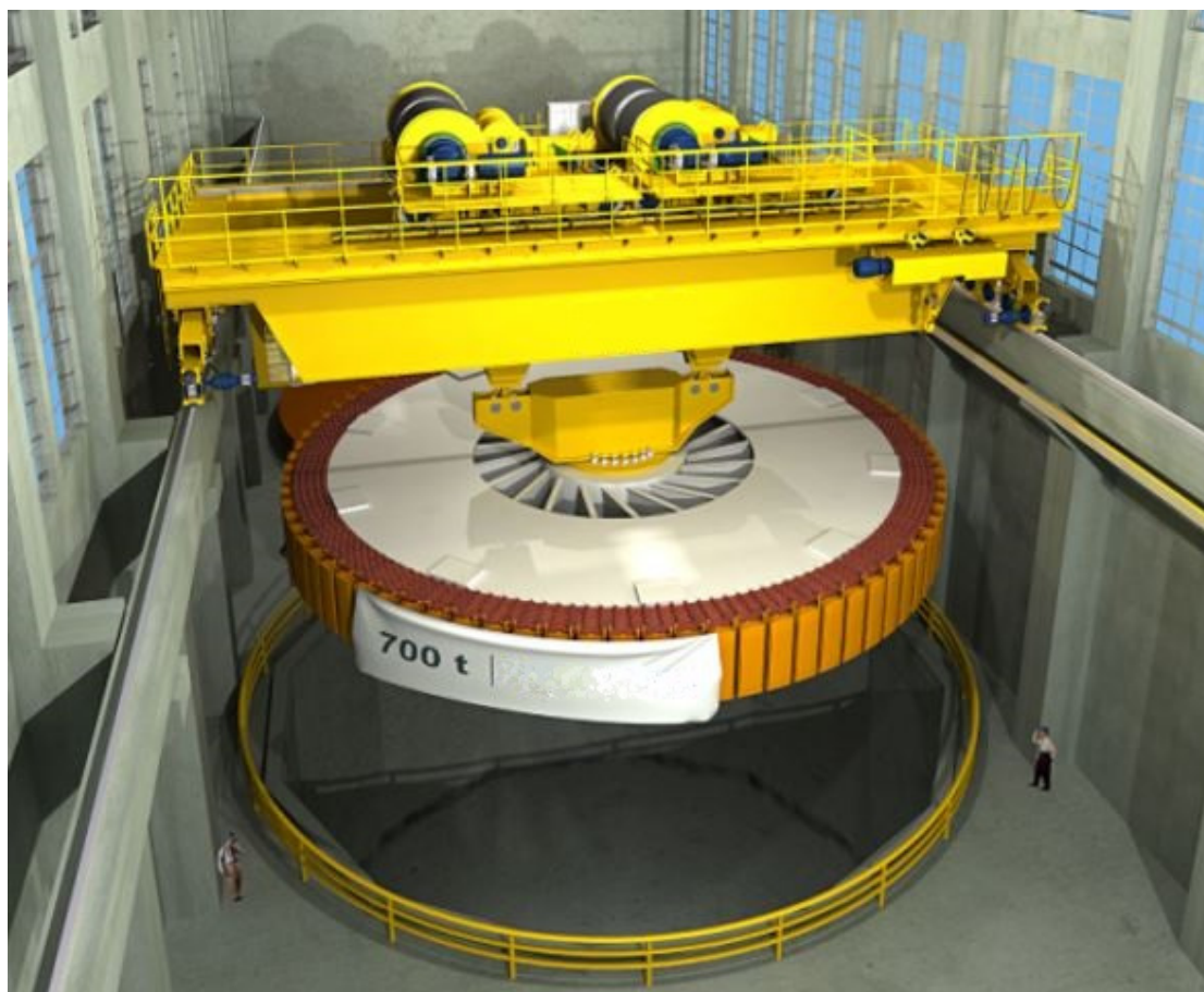
Figura 20 – Ponte rolante principal da Casa de Força.
