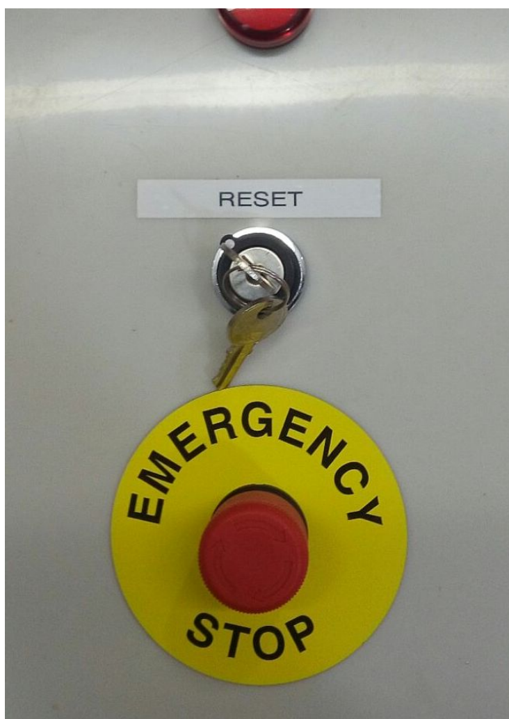
Figura 26 – Botão de Emergência
