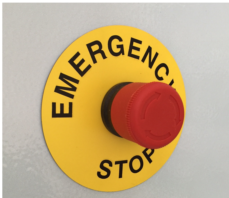
Figura 9 – Botão de Emergência
