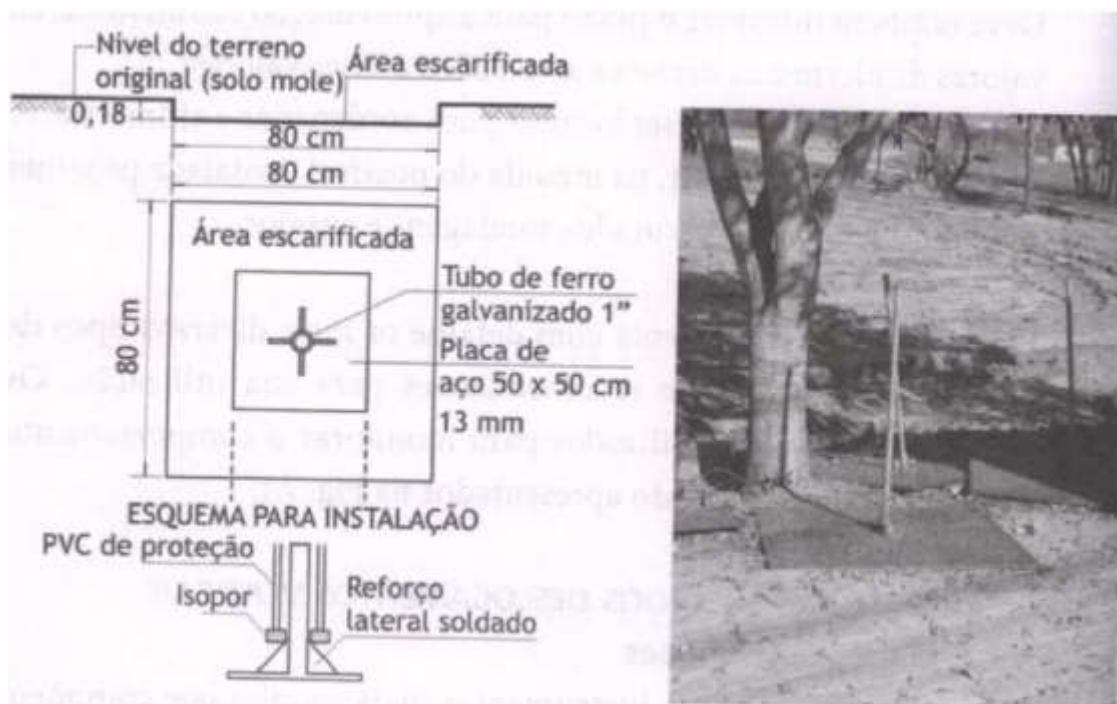
Figura 51 – Detalhe de uma placa de recalque
