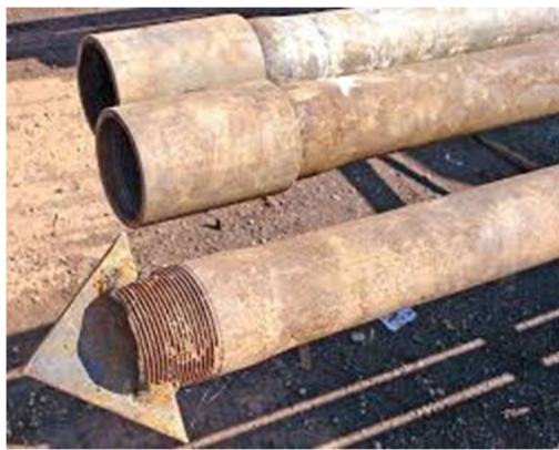
Figura 33 - Detalhe da ponta cortante a Alluvial Anker
