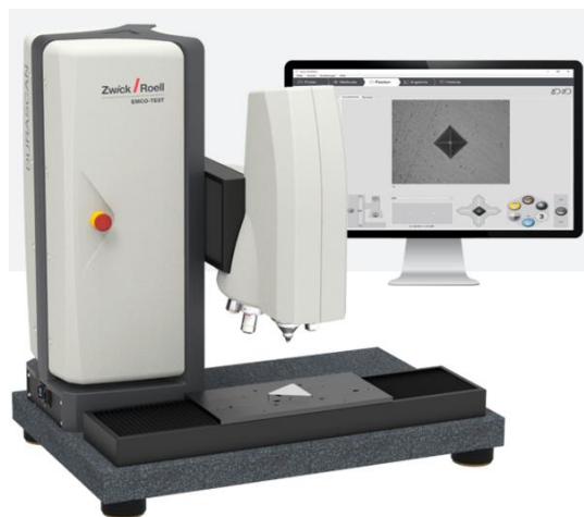
Figura 9: Durômetro utilizado para análise de micro dureza Vickers
