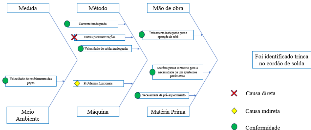
Figura 1: Diagrama de Ishikawa para trinca no processo de soldagem
