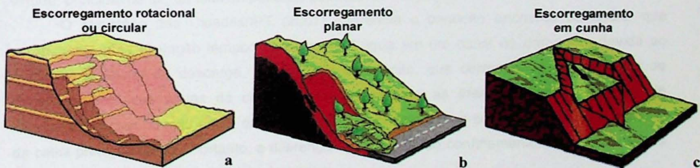
Figura 4 – (a) Esquema de escorregamento rotacional ou circular; (b) Esquema de escorregamento planar e (c) Esquema de escorregamento em cunha. Fonte: Tominaga et al. (2009).
