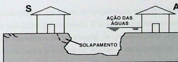
Figura 6 – Situações de risco associadas das águas, quando do registro de chuvas intensas / S – Solapamento das margens; A – Ação direta das águas. Fonte: Carvalho & Galvão (2006) às margens de córregos, em razão da possibilidade de ocorrência de solapamentos e/ou da própria ação direta).
