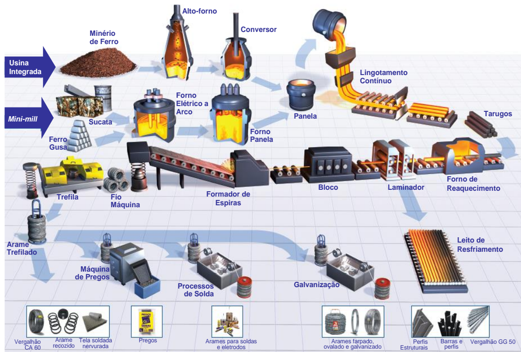
Figura 5 – Representação esquemática da produção de produtos longos a partir das rotas via alto-forno ou forno a arco.
