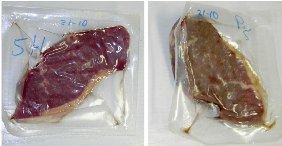
Figura 3.7 – Comparação entre embalagens plásticas a vácuo. Imagem da esquerda – Polímero DuPont Surlyn. Imagem da Direita: Polímero Convencional (Ashley, 1985).
