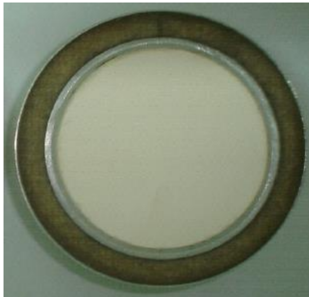
Figura 4.7 – Anel e pedra porosa de alta entrada de ar colados no top-cap (Guimarães, 2008).
