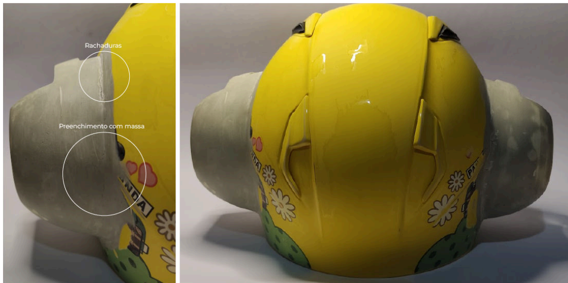
Figura 55 – Resultado do acabamento em massa automotiva no capacete
