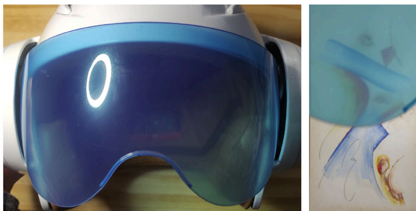
Figura 51 – Resultado do spray translúcido azul e teste de visibilidade da viseira
