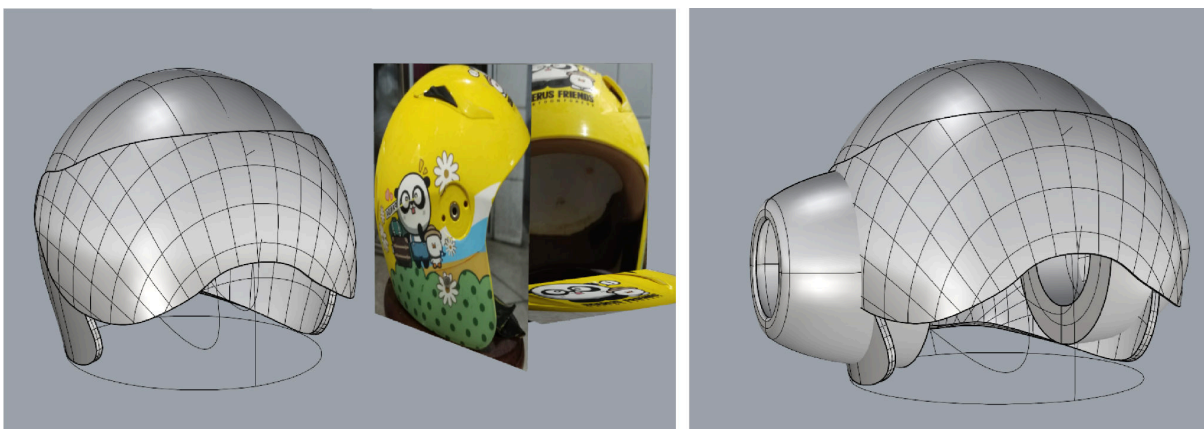
Figura 43 – Modelagem da superfície capacete para encaixe da orelha no Rhinoceros 8
