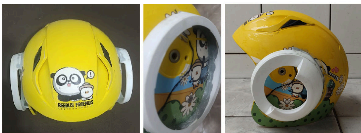
Figura 54 – Processo de colagem da peça 3D no capacete
