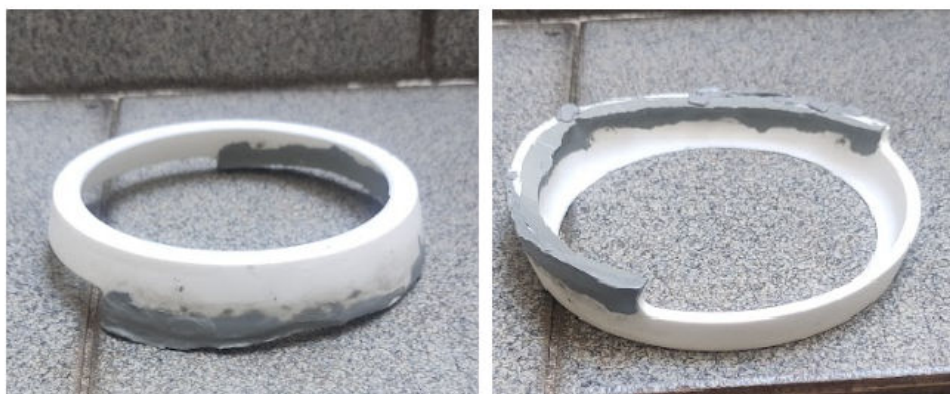
Figura 53 – Peças 3D de encaixe preenchidas com Durepoxi
