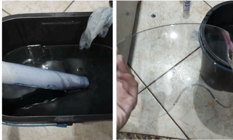
Figura 50 – Resultado do banho em corante de acrílico na viseira
