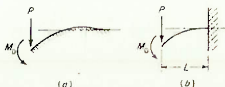
Figura 16.1. Viga em Fundação Elástica e
