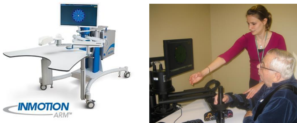
Figura 4 – Dispositivos InMotor ARM e MIT-MANUS. Fontes: respectivamente página da Bionik(4) e MIT News(5) na internet
