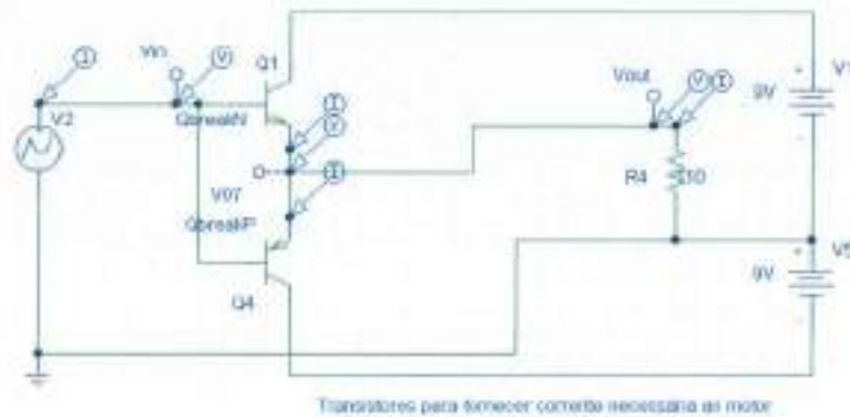
Esquemático 13: Arranjo de Transistores para Ampliar a Corrente Fornecida ao Motor.
