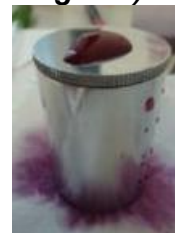
Foto 35 - Picnômetro com amostra de vinho
