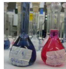
Foto 58 - Frascos com soluções para identificação de polifenóis totais (esquerda) e antocianinas (direita)
