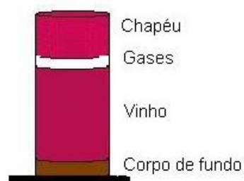
Figura 7 - Esquema da distribuição interna do mosto no barril: Chapéu, Cascas suspensas pela camada de gases, Corpo de fundo, sementes e borra depositados no fundo do barril
