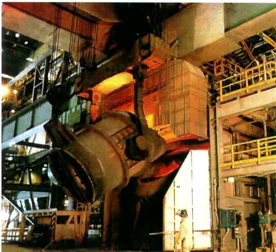
Figura 10 - Conversor a oxigênio da aciaria nº 2 da COSIPA, em 1990 [31]
