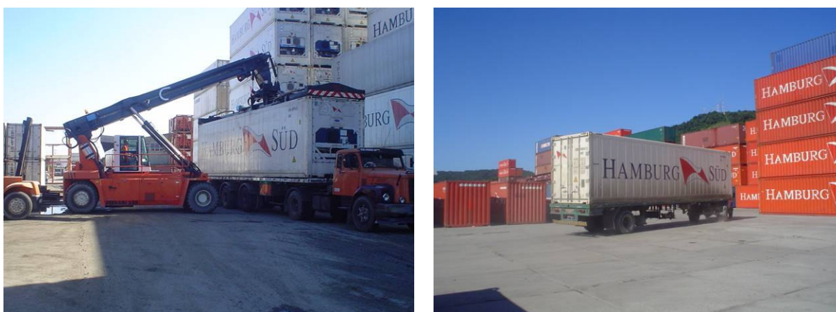
Figura 17 - Contêiner sendo colocado sobre o caminhão para liberação e saída do TCV
