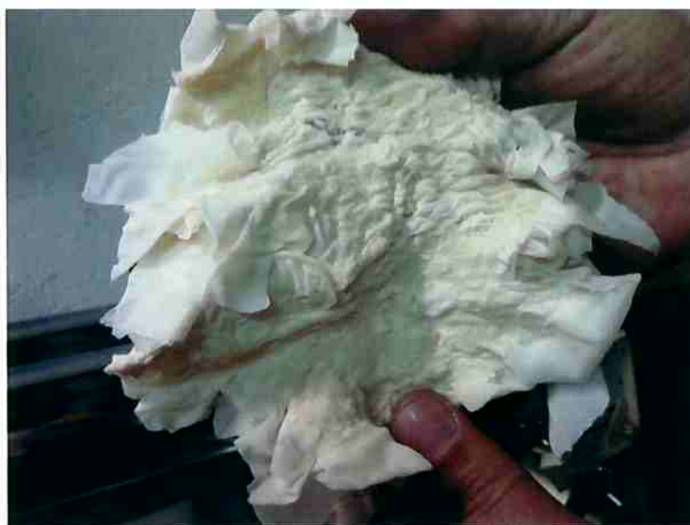
Figura 22 - Luvas picotadas após passagem pela calandra
