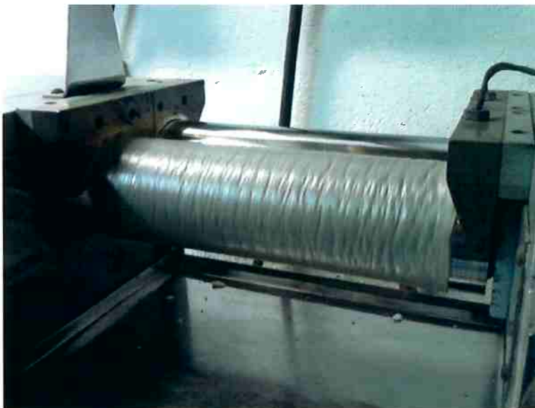
Figura 17 - Massa sendo homogeneizada na calandra
