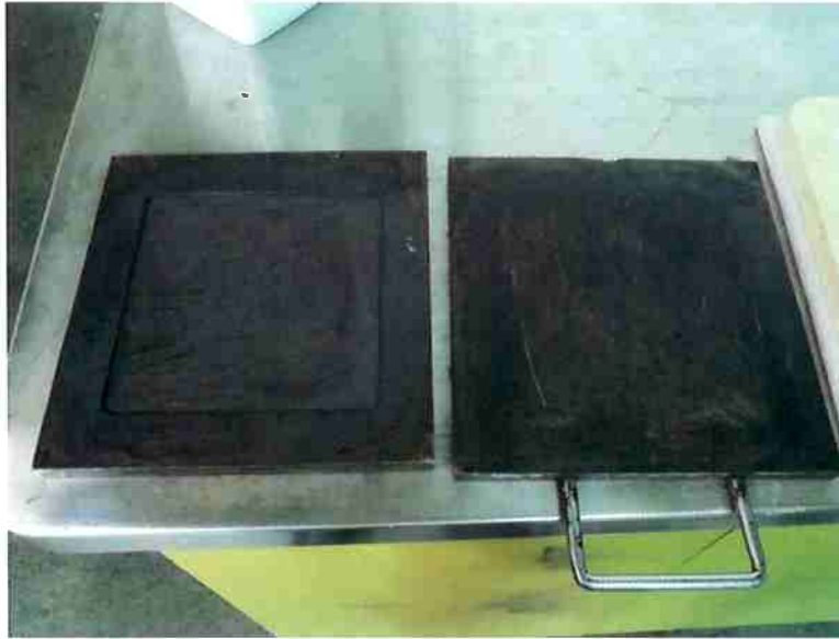
Figura 18 - Forma usada em conjunto com a prensa hidráulica
