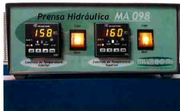
Figura 19 - Controlador de temperatura da prensa hidráulica
