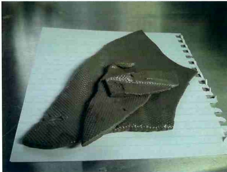
Figura 13 - Borracha natural utilizada na confecção das mantas
