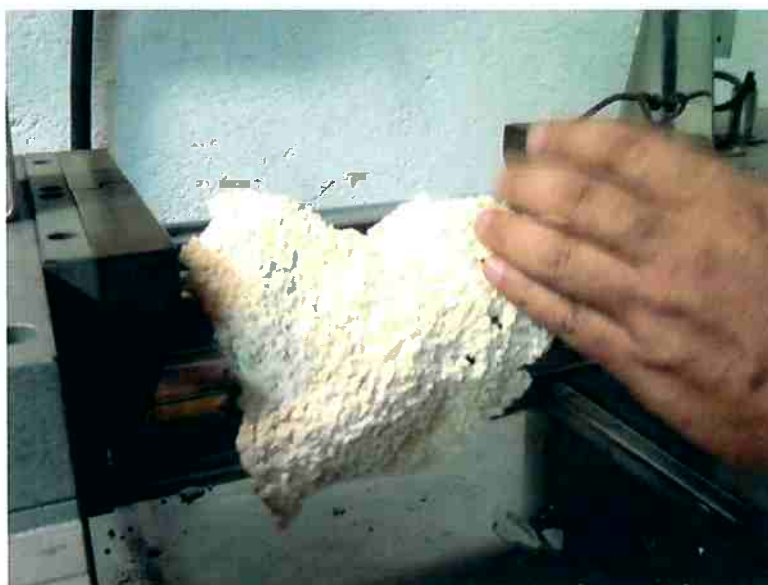
Figura 23 - Homogeneização da massa composta por luvas picotadas
