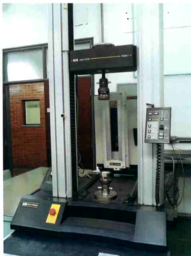
Figura 9 – Máquina de ensaio de tração da marca Instron, modelo 5667
