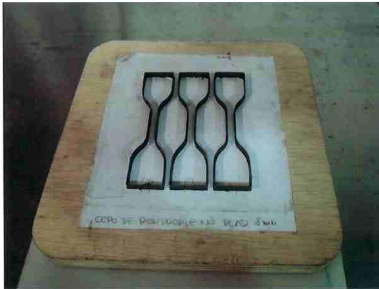
Figura 14 - Molde usado para corte dos corpos de prova a partir das mantas
