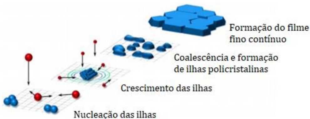
Figura 1: Mecanismo de crescimento de filmes finos sobre substratos planos.
