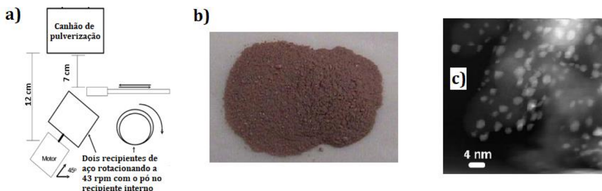
Figura 12 : a) Câmara de pulverização catódica por magnetron proposta por Veith et al ; b) \gamma\text{-Al}_2\text{O}_3 modificado com Au; c) MEV do pó de de \gamma\text{-Al}_2\text{O}_3 modificado com Au.
