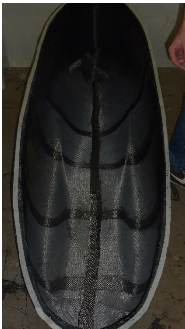
Figura 15: Esqueleto da carenagem (Fonte: Autor, 2017)
