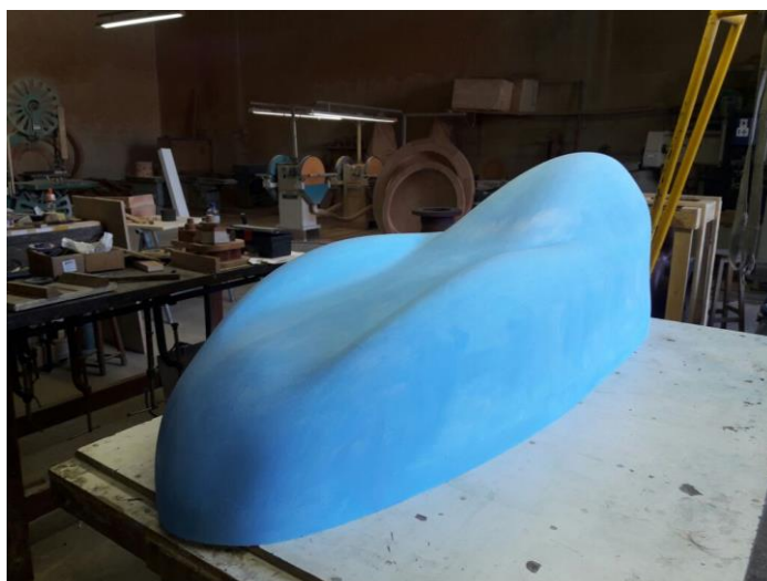
Figura 8: Pré-molde finalizado com 25mm de comprimento a mais em sua base (Fonte: Autor, 2017)
