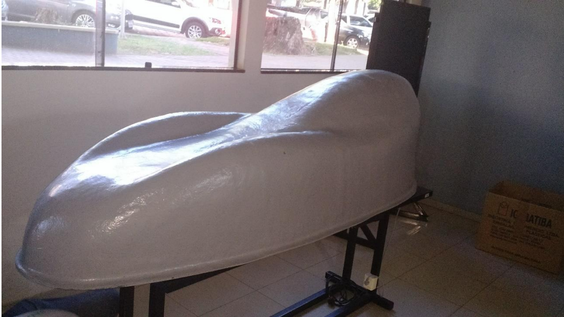
Figura 9: face externa do molde em PRFV (Fonte: Autor 2017)
