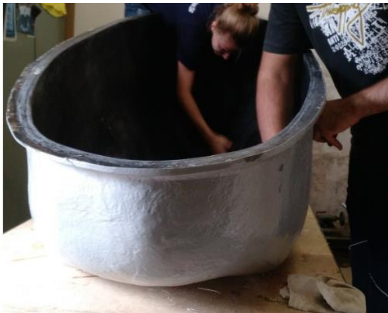
Figura 10: face interna do molde com demonstração do gel coat e abas laterais para fixação do tacky tape (Fonte: Autor 2017)
