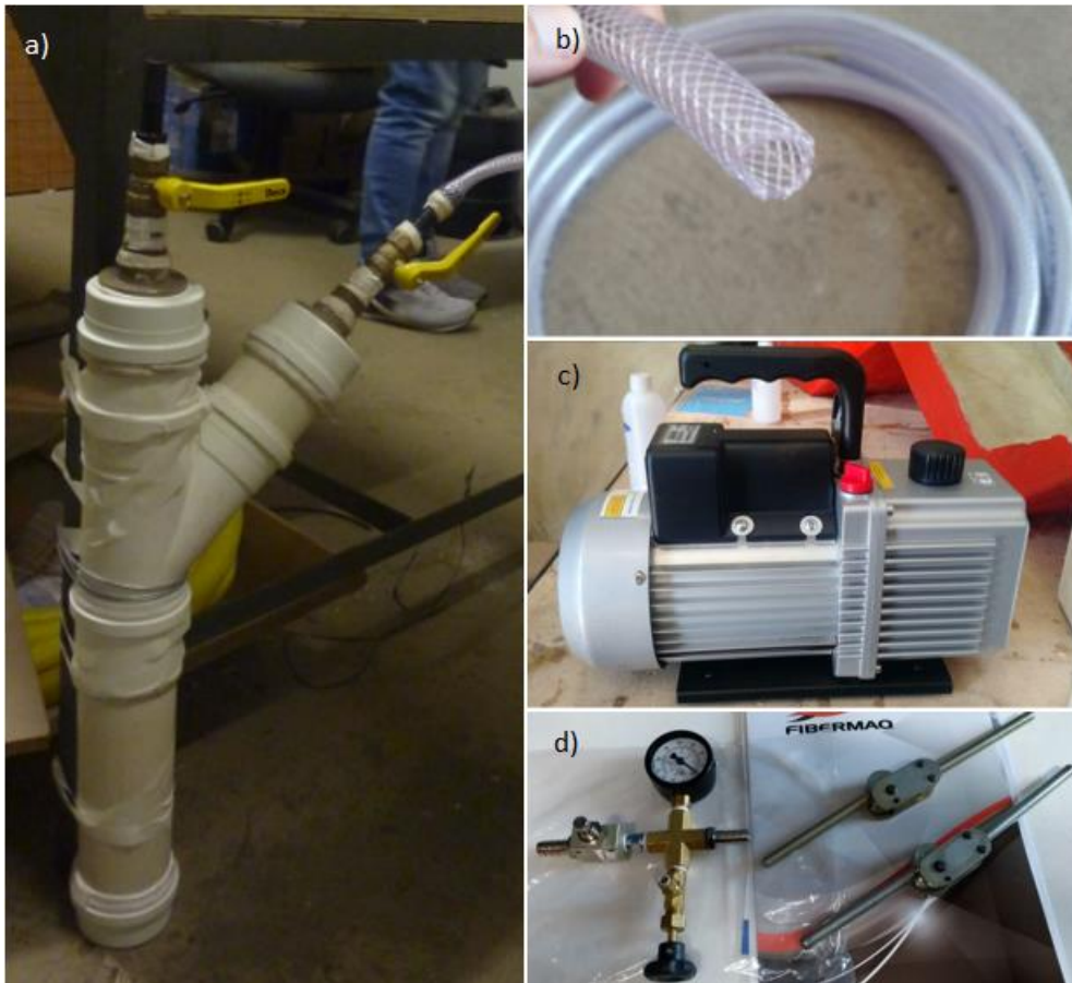
Figura 11: a) Resin trap preso ao pé da bancada. b) Mangueira transparente reforçada. c) Bomba de vácuo. d) Vacuômetro e estranguladores. (Fonte: Autor 2017)
