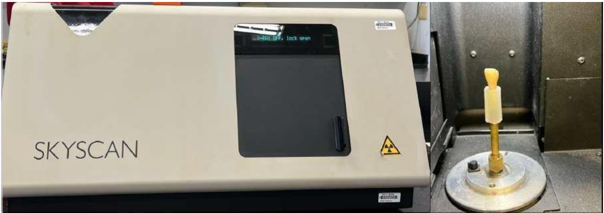
Figura 1. (A) Microtomógrafo de alta resolução(SkyScan 1174). (B) Espécime posicionado em tubo de polietileno, perpendicular à fonte de radiação
