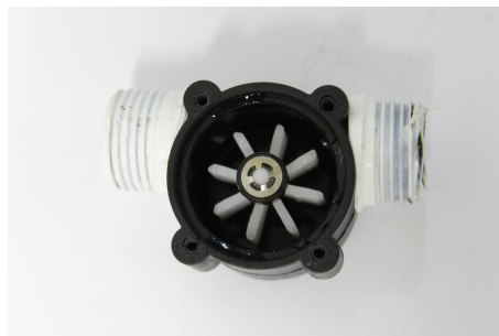
Figura 8: Interior do medidor de vazão
