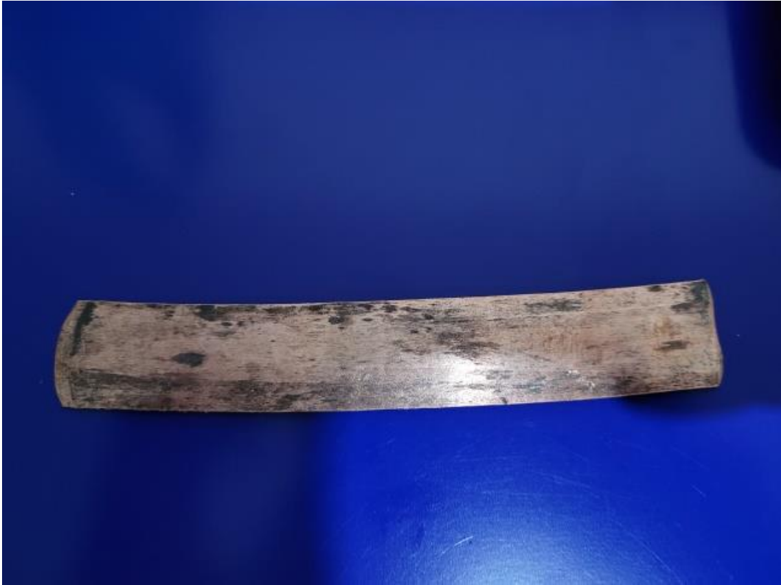
Figura 26: Amostra de cobre após a laminação
