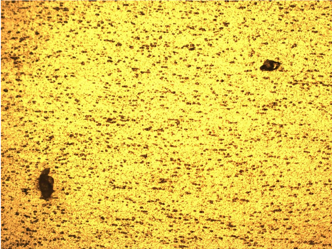
Figura 32: Amostra de alumínio sem recozimento (200x de aumento)
