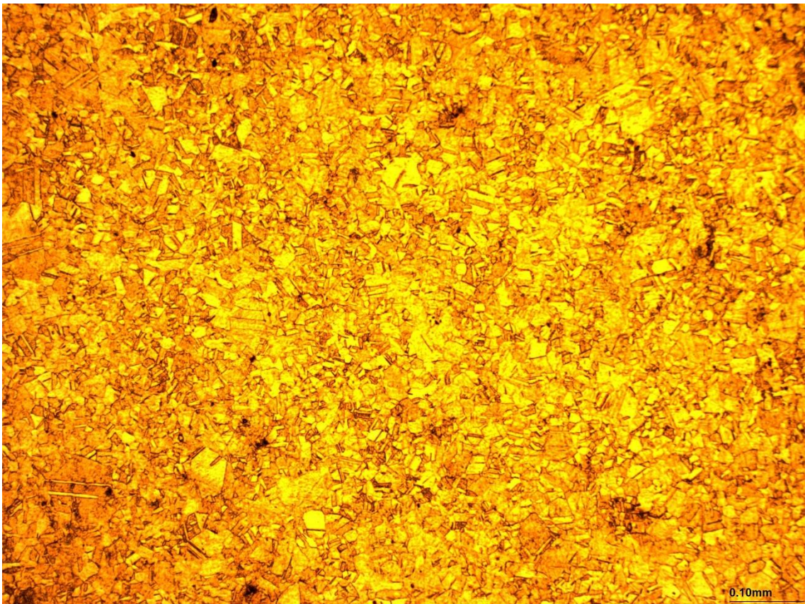
Figura 28: Amostra de cobre com 15 minutos de recozimento (aumento de 100x)
