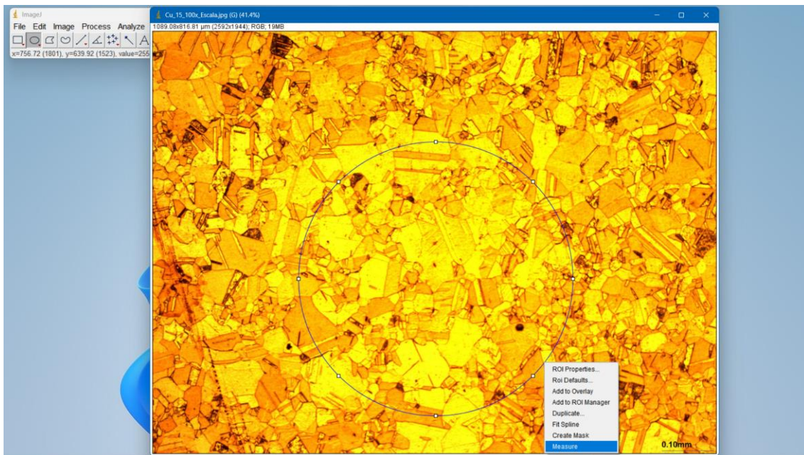
Figura 22: Utilização da ferramenta Measure no ImageJ
