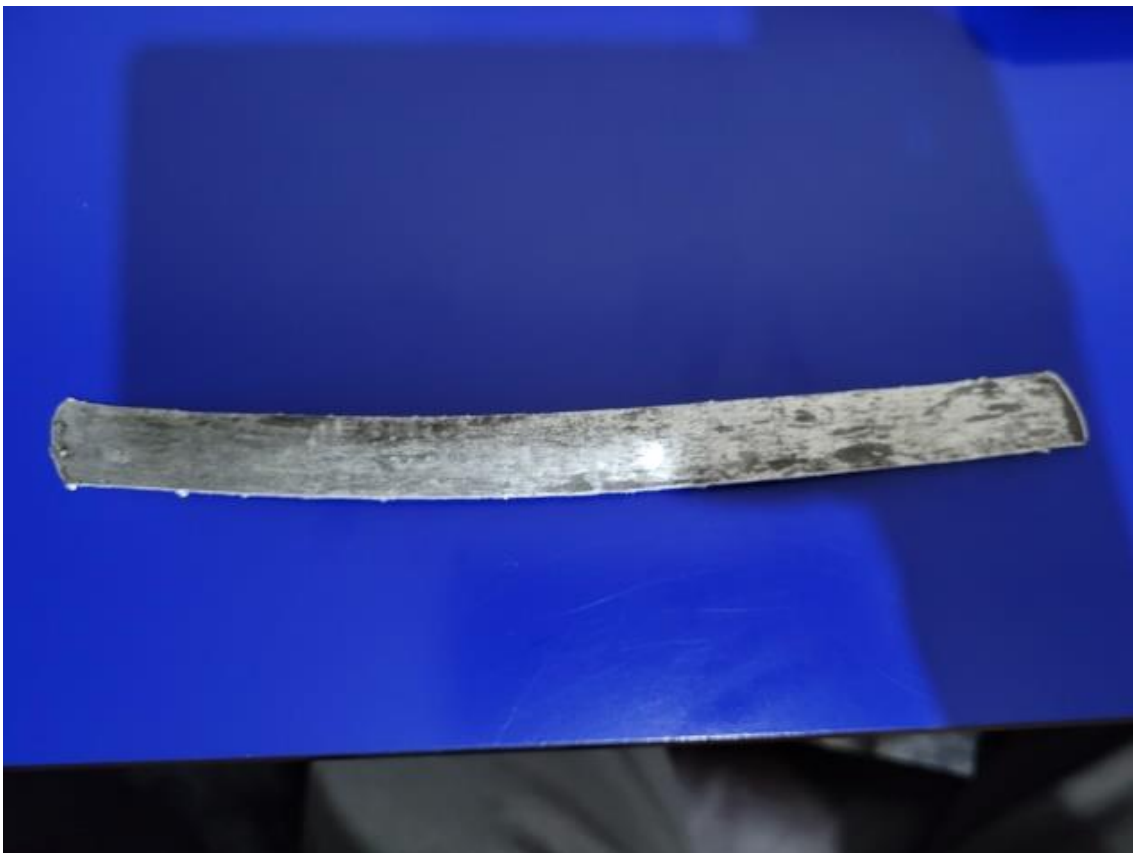
Figura 25: Amostra de alumínio após a laminação
