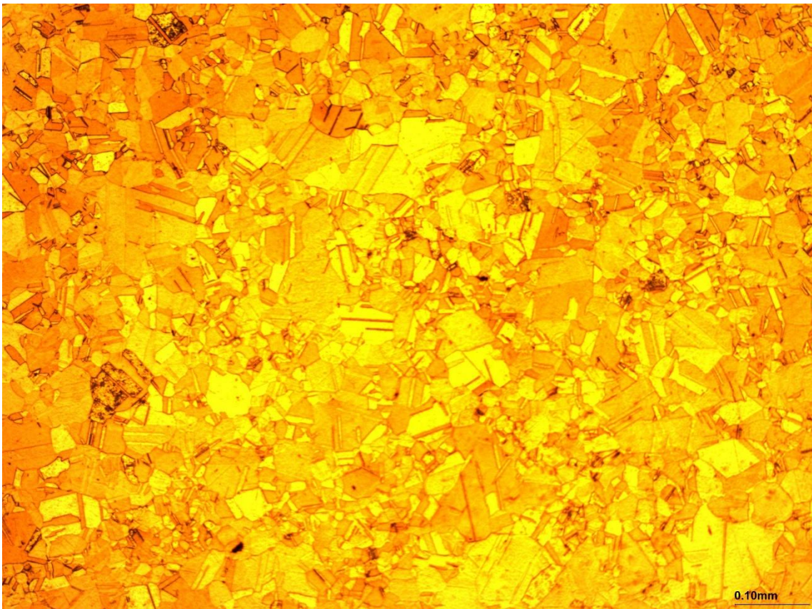
Figura 30: Amostra de cobre com 1 hora de recozimento (aumento de 100x)
