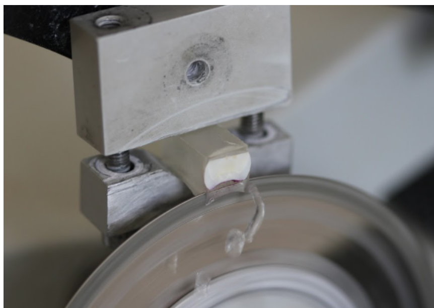
Figura 9: dente estabilizado e sob processo de fragmentação na máquina de cortes. Fonte: próprio autor.
