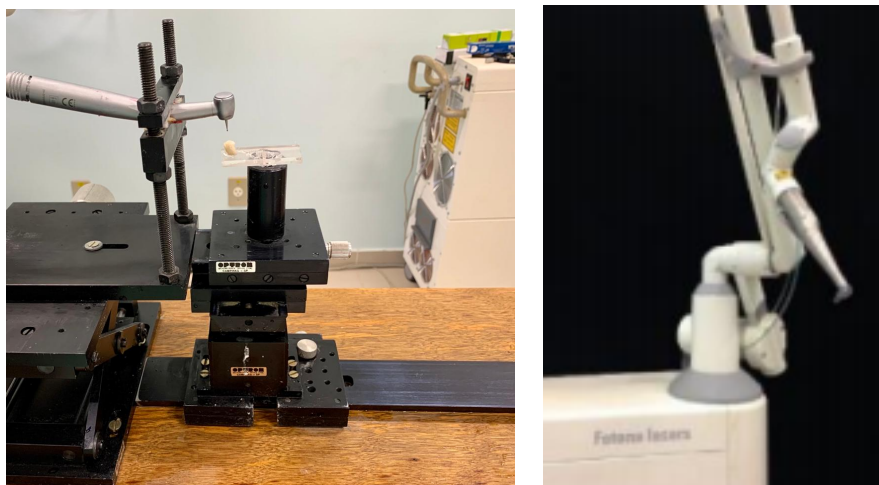
Figura 2: Máquina de varredura e laser de Er: YAG (Fidelis Er III, Fotona, Ljubljana, SLOVENIA).
