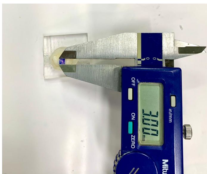
Figura 1: Conferência do template com paquímetro.
