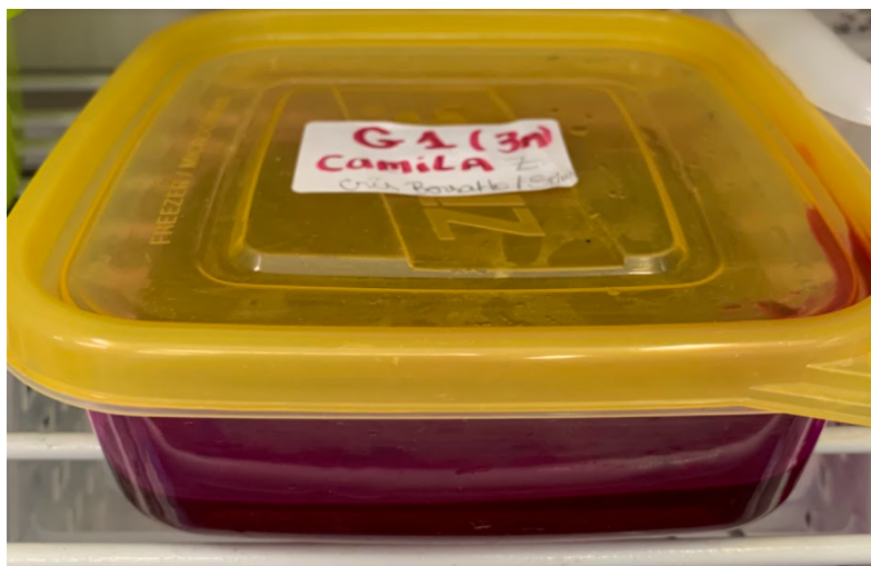
Figura 6: imersão de amostras em Rodamina B 0,2% à 37°C. Fonte: próprio autor.
