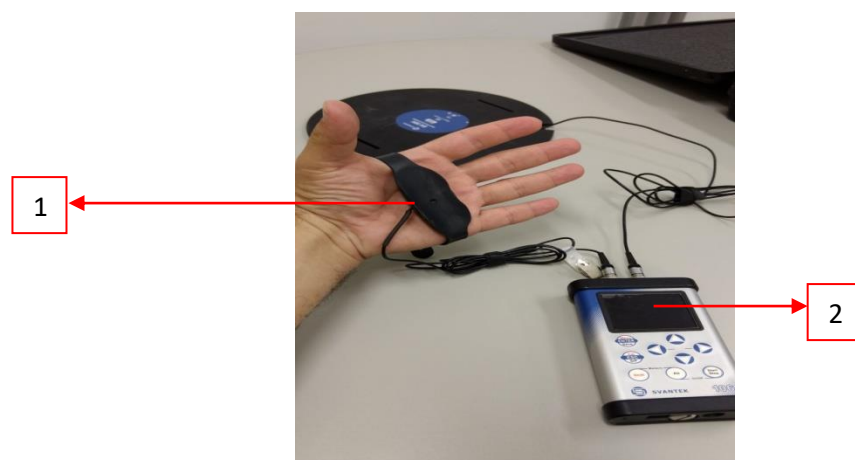
Figura 10 - Montagem do sistema: medidor e acelerômetro
