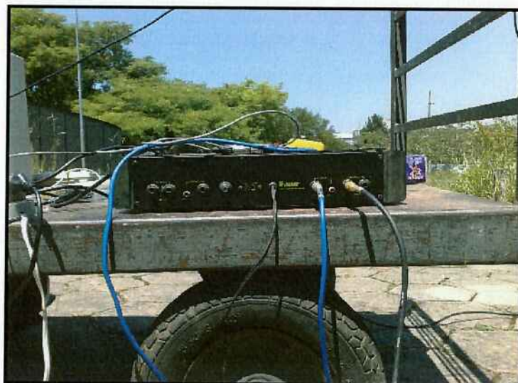
O Amplificador de potência e seu input, aonde vai ligado o computador, e o output, aonde vai ligado o alto-falante
