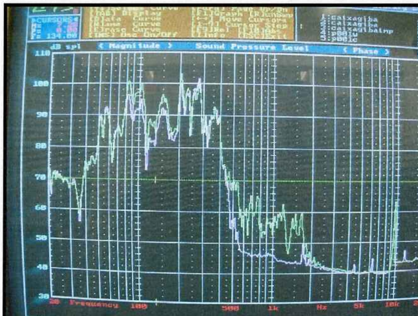
Filtro passa baixas com compensação (verde) e sem compensação (roxo)
