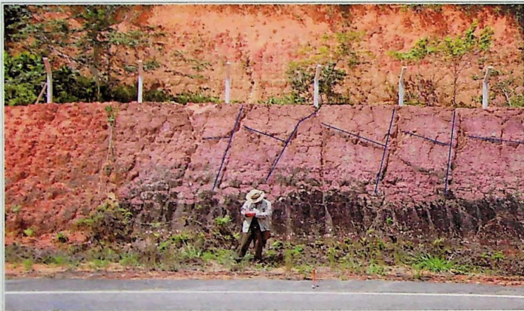
Figura 13 – Exemplo de famílias de juntas (em azul) no arenito caulínítico da Formação Alter do Chão.
