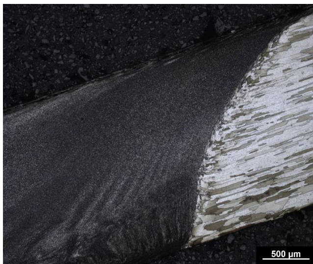
Figura 34: Nugget e lado de avanço. Micrografia de microscopia ótica; material atacado com Kroll (Fonte:
