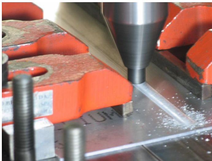
Figura 13: Soldagem FSW sendo executada na chapa da liga AA2524-T3. Foto realizada nas dependências do CNPEM – LNNano. (Fonte: Autor, 2017).
