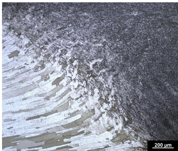
Figura 35: Lado de retrocesso. Micrografia de microscopia ótica; material atacado com Kroll
