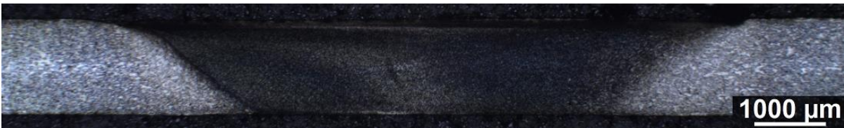
Figura 37: Visão panorâmica da solda FSW feita nas chapas de alumínio AA2524-T3. Solda conseguida no teste 4. Micrografia de microscopia ótica; material atacado com Kroll (Fonte: Autor,2017)
