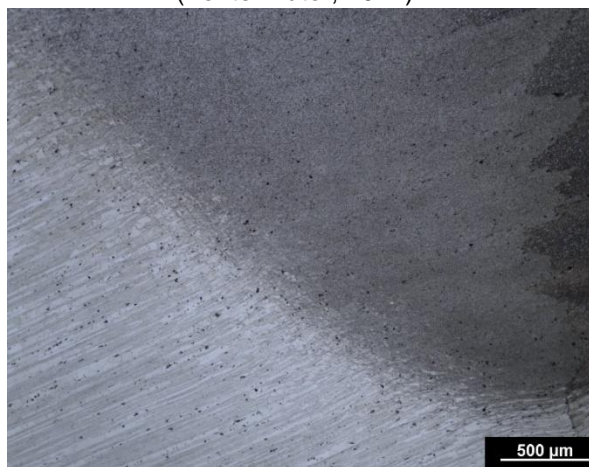
Figura 46: Lado de retrocesso. Micrografia de microscopia ótica; material atacado com Kroll (Fonte: Autor, 2017).
