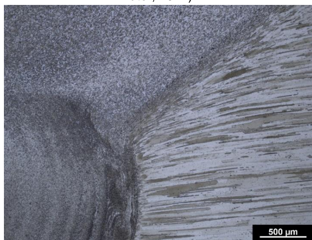
Figura 45: Lado de avanço. Micrografia de microscopia ótica; material atacado com Kroll (Fonte: Autor, 2017).
