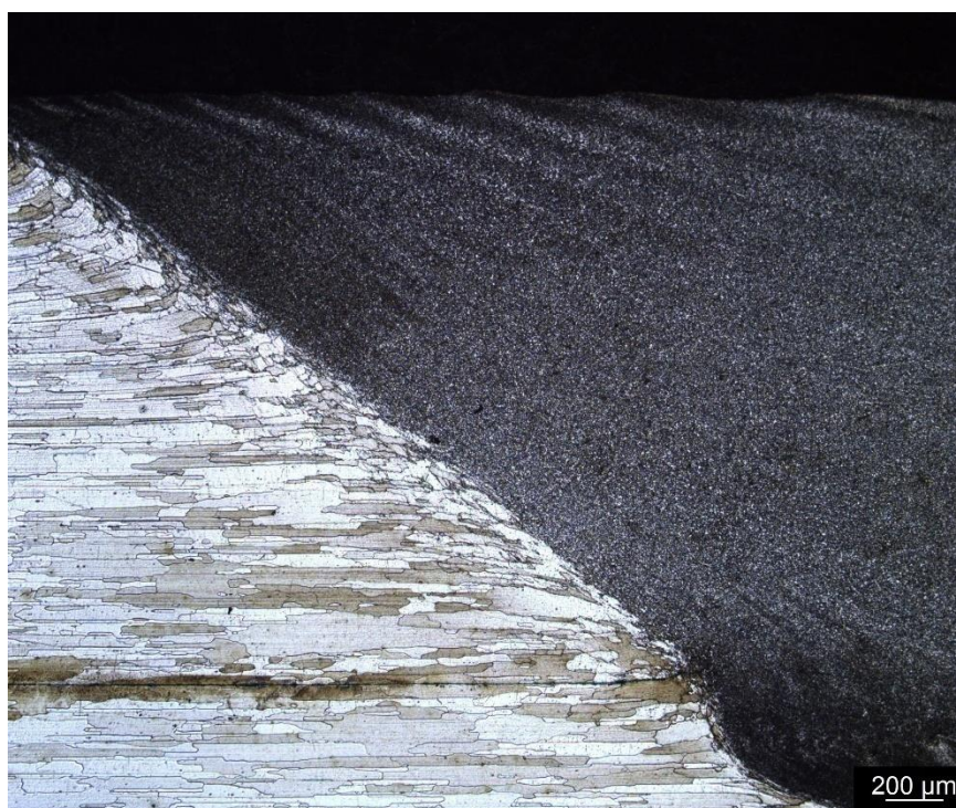
Figura 29: Soldagem sobreposta FSW realizado nas chapas AA 2198. Esta imagem objetiva detalhar a penetração do pino no lado de avanço (Fonte: Autor, 2017).
