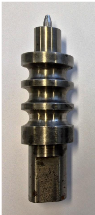
Figura 24: Ferramenta utilizada para a soldagem FSW de junta dissimilar [30].
