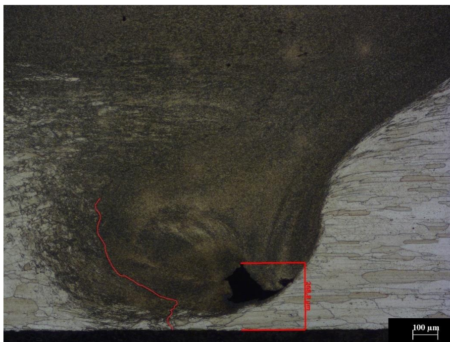
Figura 26: Soldagem FSW realizado nas chapas AA 2198. Imagem referente ao teste 2, destacando a presença de uma grande trinca (linha vermelha) e um poro. (Fonte: Autor,2017).
