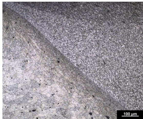
Figura 39: Lado de avanço e nugget. Micrografia de microscopia ótica; material atacado com Kroll
