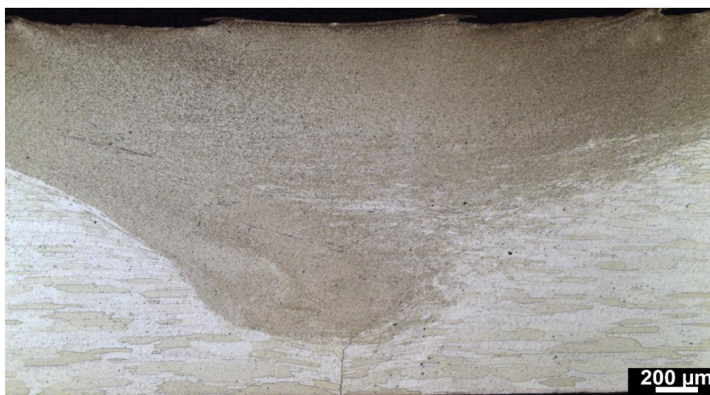
Figura 2214: Soldagem FSW realizado nas chapas AA 2198. Imagem referente ao teste 1, destacando-se a falta de pene-tração. (Fonte: Autor, 2017).
