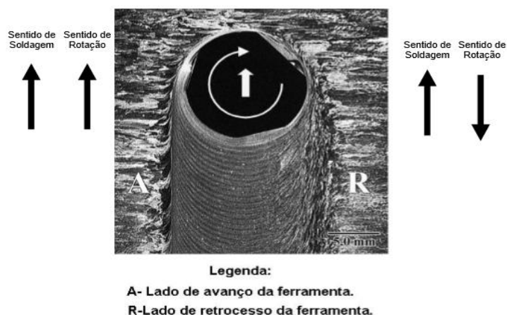
Figura 5: Processo de soldagem FSW evidenciando os lados de avanço e retrocesso [18].
