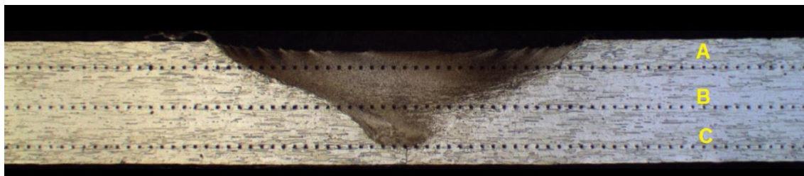
Figura 17: Ensaio de microdureza feito na liga AA2198-T851. A letra (A) indica a linha de indentação superior, a letra (B) a linha mediana e (C) a linha inferior. (Fonte: Autor, 2017).
