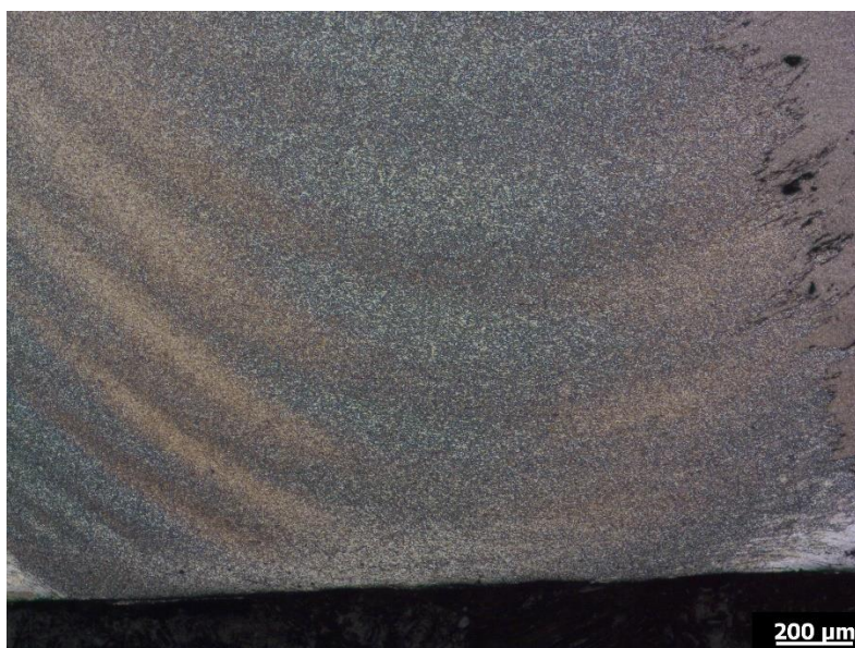
Figura 27: Soldagem FSW dissimilar realizada no teste 2. Esta figura destaca a raiz da solda, evidenciando adequada penetração. Nota-se também a interface entre as duas ligas e presença de linha de junta remanescente e po-ros. (Fonte: Autor, 2017).
