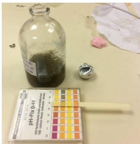
Figura 6: Medição de pH do meio aquoso interno a partir de indicador ácido base, ao término do experimento. (Fonte: o autor).
