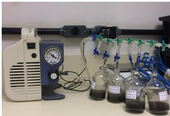
Figura 5. Processo de evacuação e inserção de N_2 nos vials já preenchidos com o conteúdo para análise.
