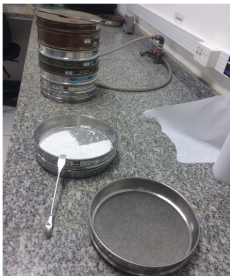
Figura 4. Peneiras utilizadas para seleção e homogeneização granulométrica da gipsita moída, para preparação dos experimentos.
