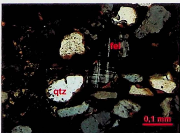
Figura 20. Arenito com arcabouço com grãos de quartzo (qtz) e feldspato (fel) da fácies de duna da ocorrência Betumita. Imagem sob nicóis cruzados.
