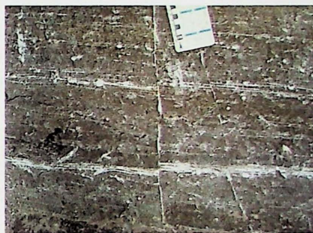
Figura 12. Fratura posterior à impregnação por óleo na ocorrência Betumita. Ausência de óleo ao longo da fratura indicaria migração terciária.
