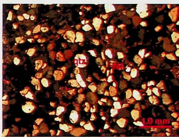
Figura 19. Arenito com arcabouço de grãos de quartzo (qtz) e feldspato (fel) impregnado com betume na fácies de duna da ocorrência Betumita. Imagem sob nicóis cruzados.
