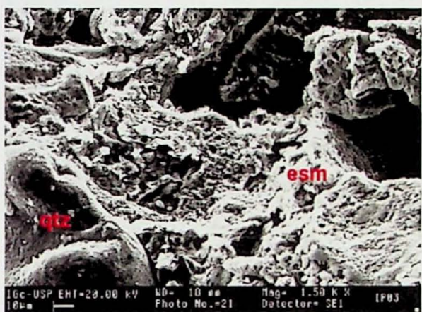
Figura 24. Esmectita (esm) com aspecto "amassado" em grão de quartzo (qtz) na fácies de interduna da ocorrência Morro do Bofete. Imagem de MEV sob detector de elétrons secundários.
