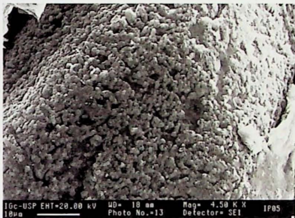
Figura 30. Grão de quartzo com envelope de cimento de calcedônia na fácies de interduna da ocorrência Betumita. Imagem de MEV sob elétrons secundários.
