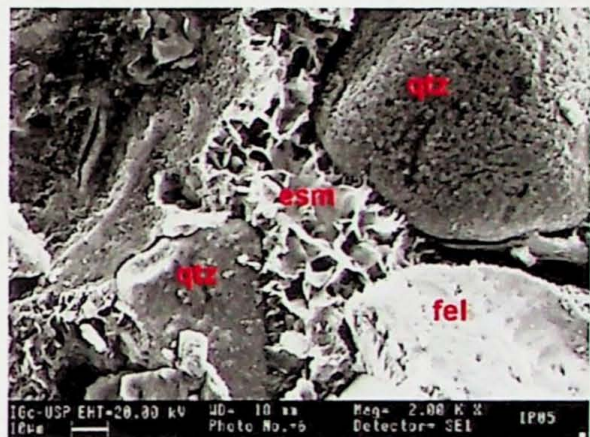
Figura 31. Grão de quartzo (qtz) com envelope de cimento de calcedônia e grão de feldspato (fel) em contato com lamelas lisas de esmectita (esm) na fácies de interduna da ocorrência Betumita. Imagem de MEV sob elétrons secundários.
