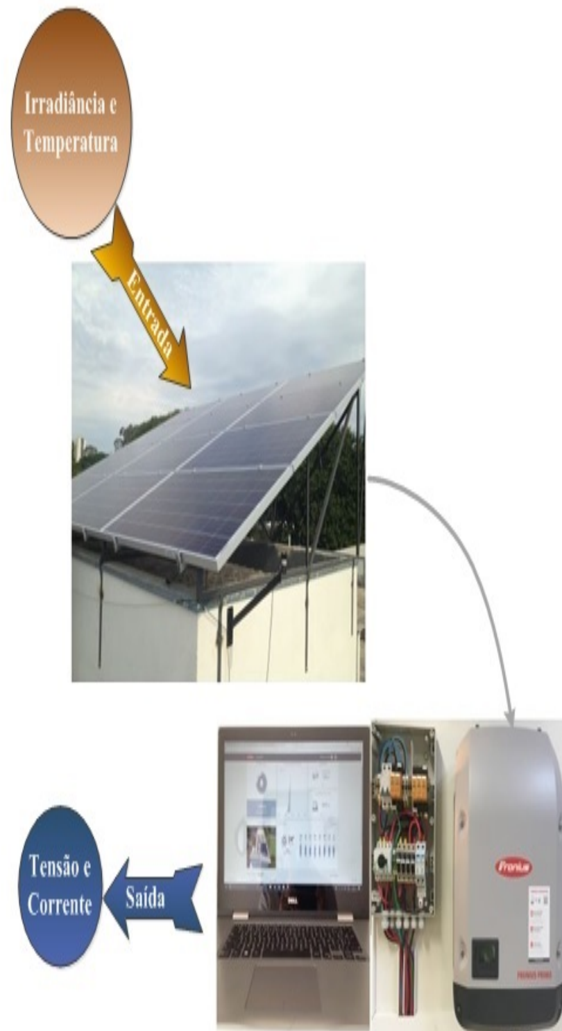
Figura 5.8: Sistema fotovoltaico foi instalado no LACOSEP (LOPES, 2018)
