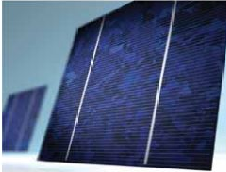
Figura 3.2: Ilustração do material utilizado para fabricação de células de silício policristalinas
