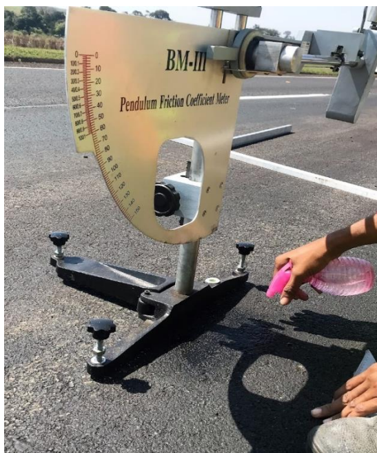
Figura 89 - Verificação de atrito: Umidificação do pavimento
