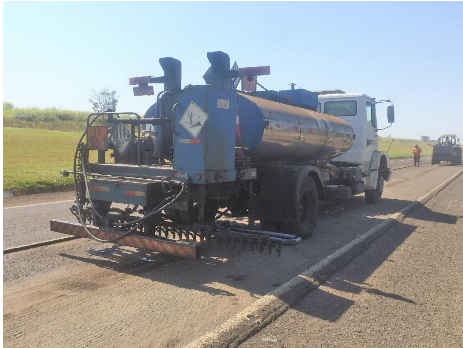
Figura 21 - Equipamento utilizado para aplicar a pintura: barra espargidora
