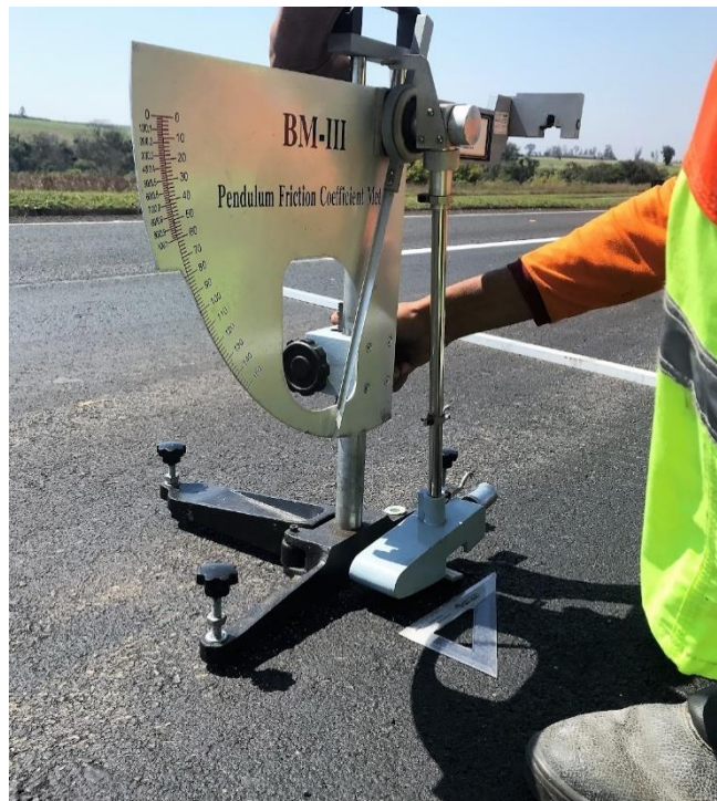
Figura 88 - Verificação de atrito: Determinação da altura do pêndulo
