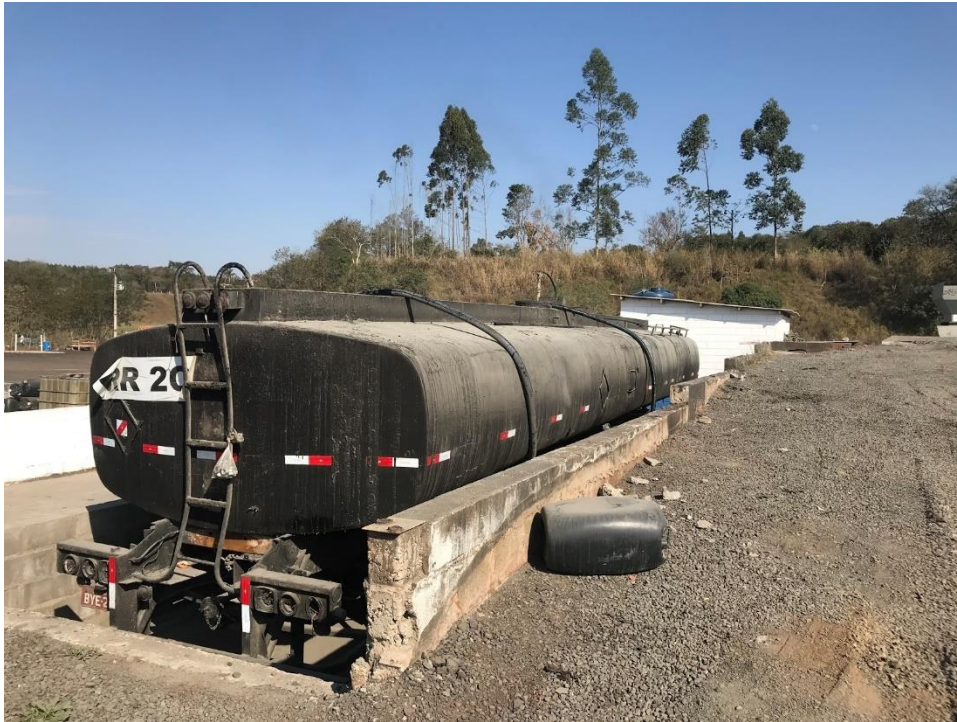
Figura 33 - Tanque de armazenamento da emulsão asfáltica RR-2C
