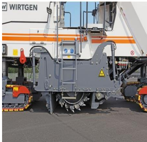
Figura 18 - Fresadora com tambor de fresagem padrão visto lateralmente
