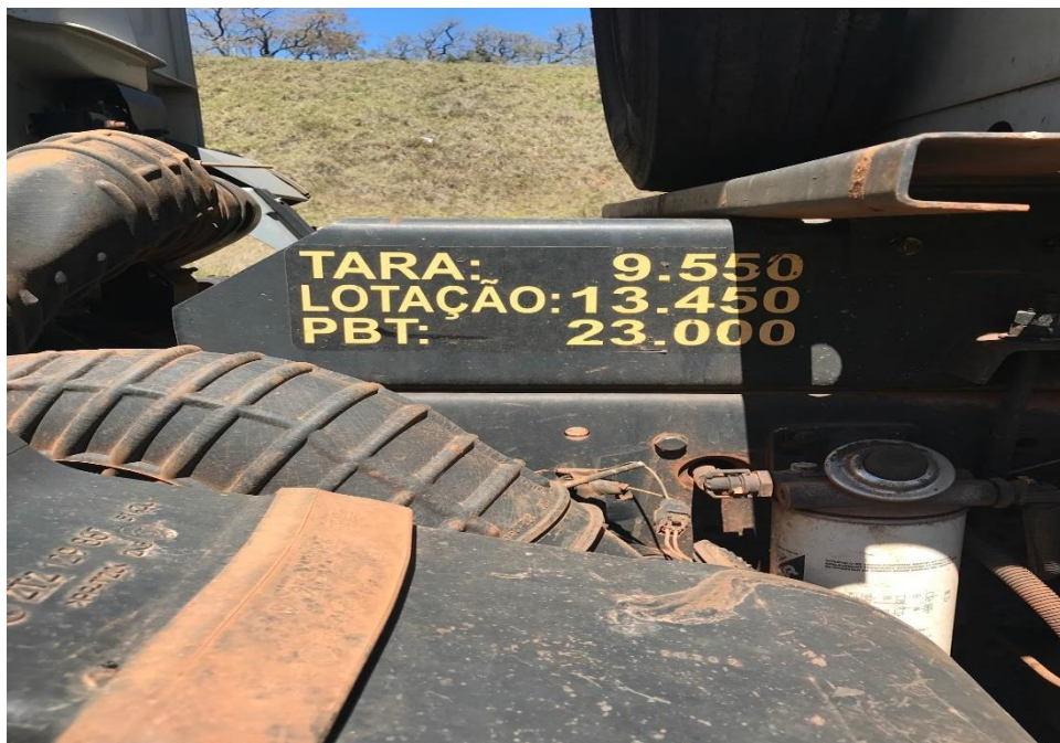
Figura 106 - Limites de carga do caminhão vasculante para transporte de concreto asfáltico
