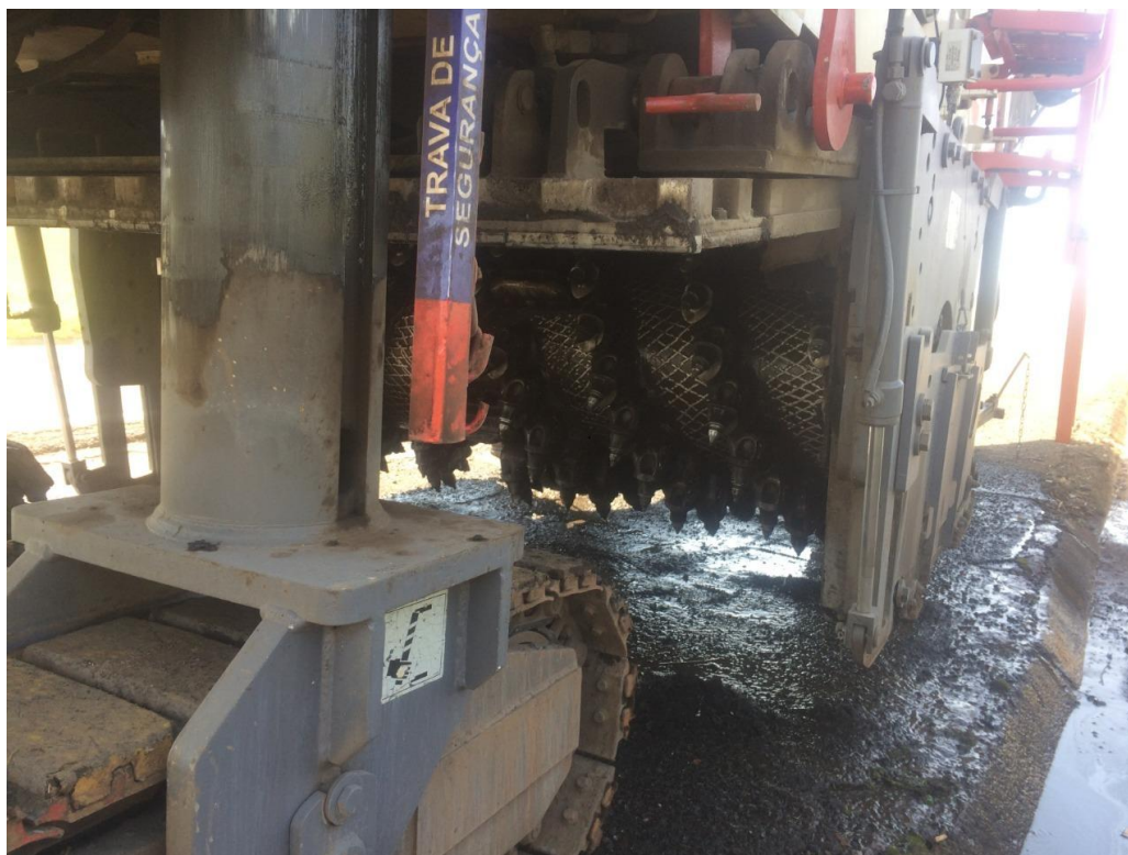
Figura 55 - Detalhe do tambor da fresadora
