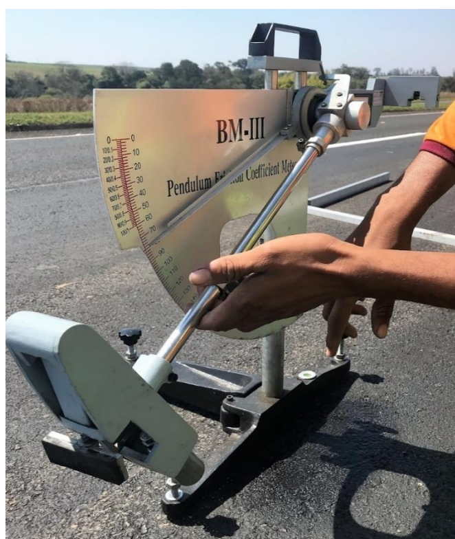
Figura 90 - Verificação de atrito: Obtenção do resultado
