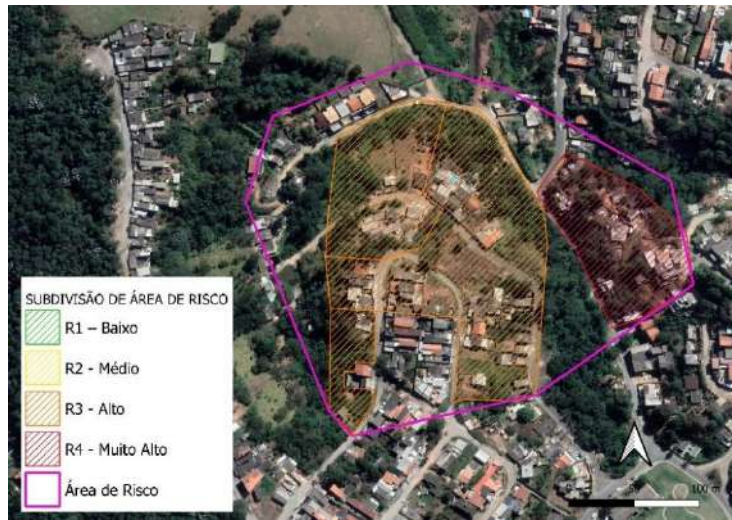
Figura 19– Exemplo de setorização a partir de área de risco. Fonte: Elaborado pelo autor.
