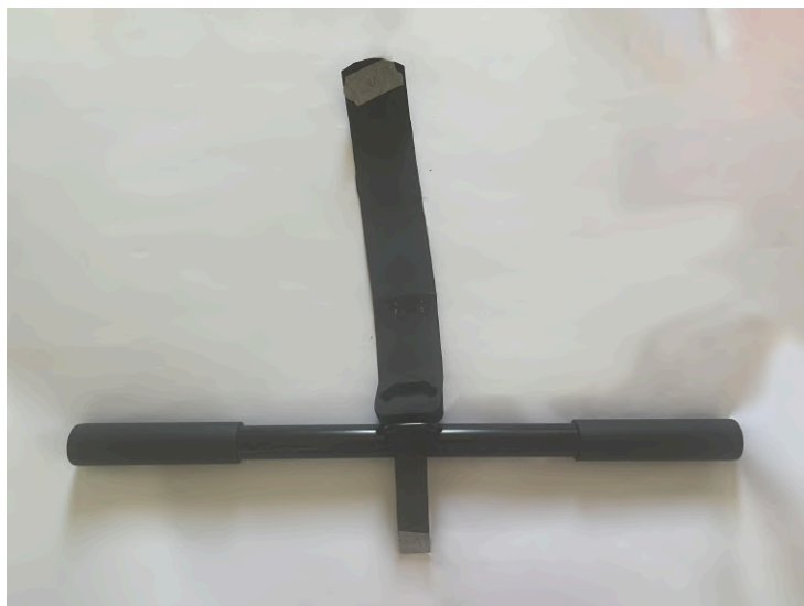
Figura 77 - Modelo de estudo do berço do sensor com cinta de fixação
