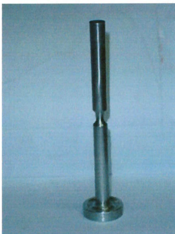
Figura 23 – Molde com estenose – 50% de redução da secção da artéria
