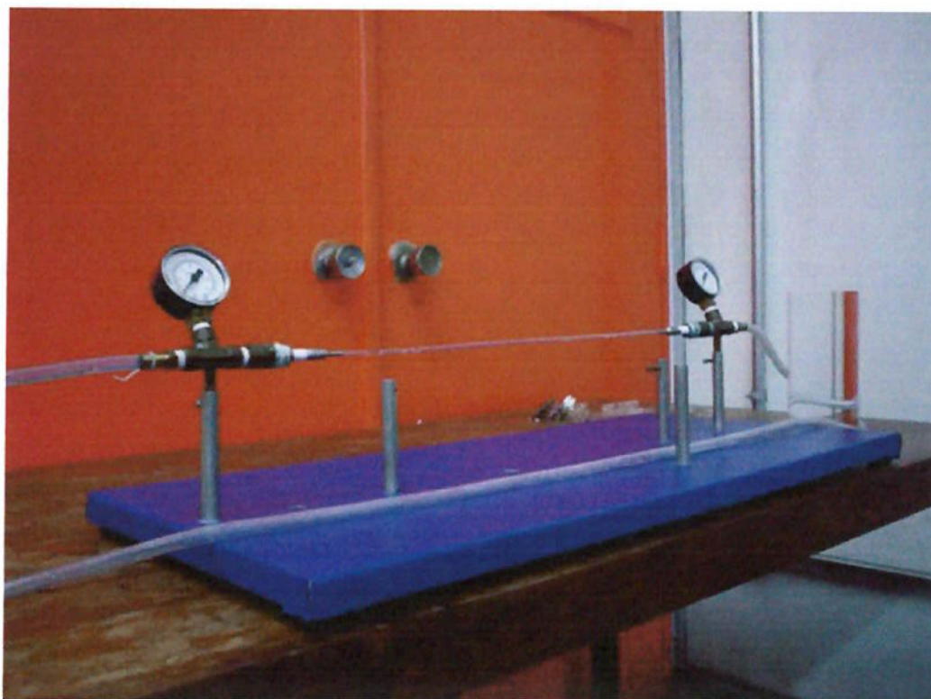
Figura 20 – Módulo de ensaio com tubo capilar
