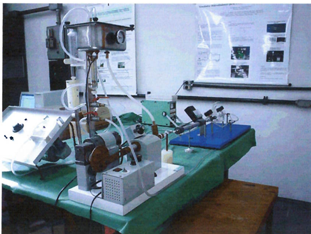
Figura 11 - Simulador hidrodinâmico para estudos in vitro do sistema cardiovascular
