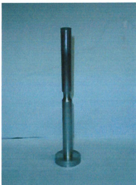
Figura 22 – Molde com estenose - 30% de redução da secção da artéria
