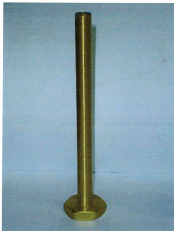
Figura 21 – Molde sem estenose usinado em cobre
