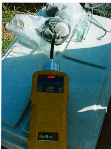
Foto 11: Leitura de VOCs utilizando um PID Mini Rae
