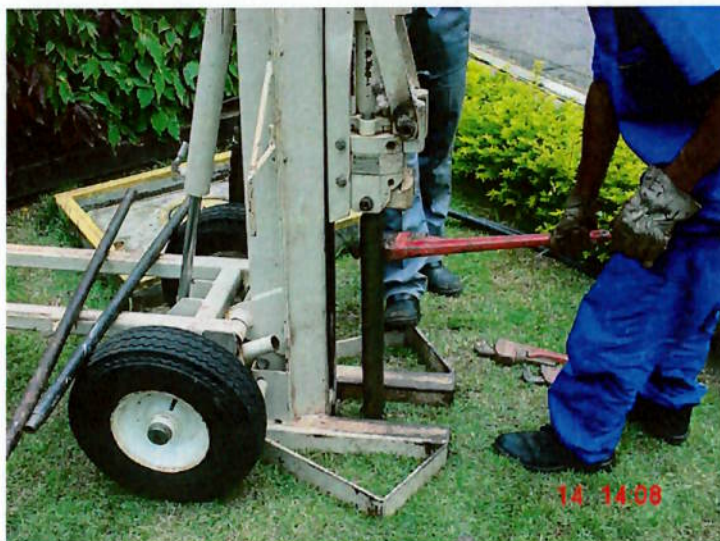
Foto 8: Sistema Direct push com o amostrador de solo
