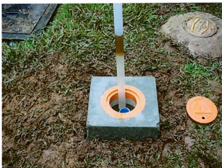
Foto 13: Medição de nível d'água e presença de fase livre de produto
