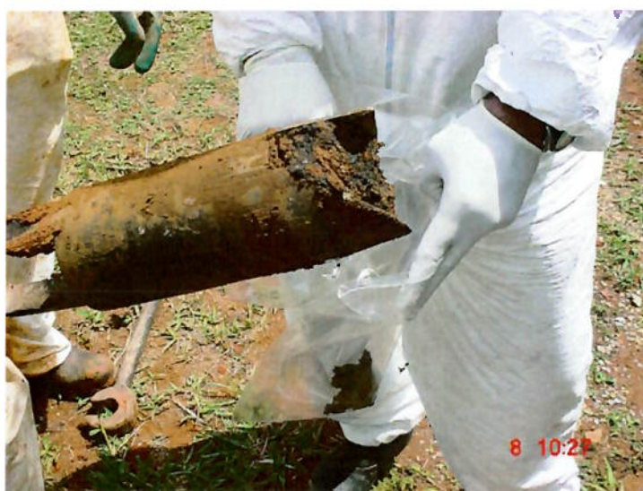
Foto 9: Coleta de amostra de solo em sacos plásticos inertes
