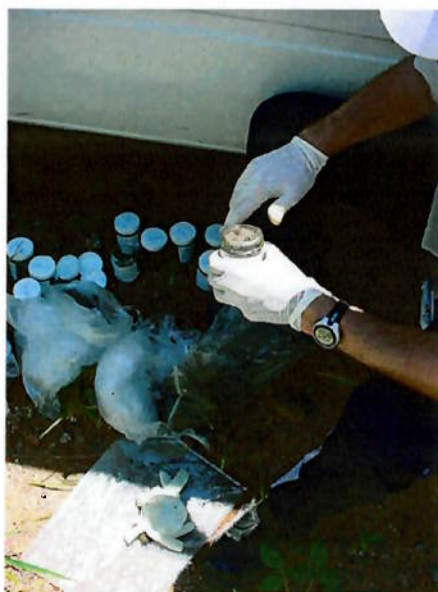
Foto 12: Acondicionamento de amostras de solo em frascos específicos para envio ao laboratório
