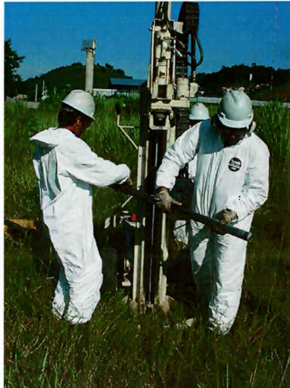
Foto 6: Sistema Direct push com o amostrador de solo
