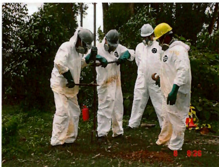
Foto 1: Equipe realizando perfuração a trado manual
